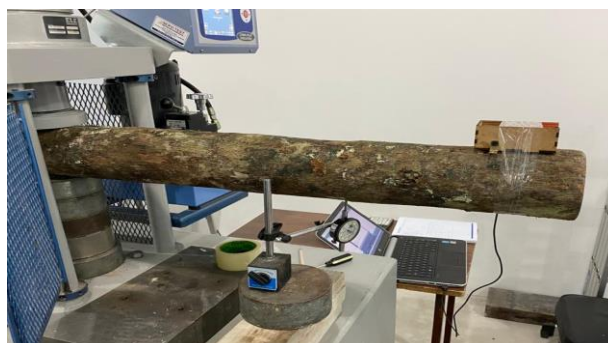
Figura 36. Apoyo Empotrado. Fuente: Los Autores.
