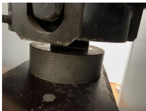
Figura 34. Ensayo de compresión perpendicular a la fibra.
