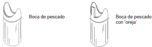
Figura 3. Entalladura boca de pescado.
