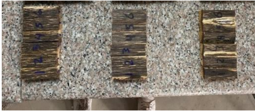
Figura 35. Probetas ensayadas a compresión perpendicular a la fibra. Fuente: Los Autores
