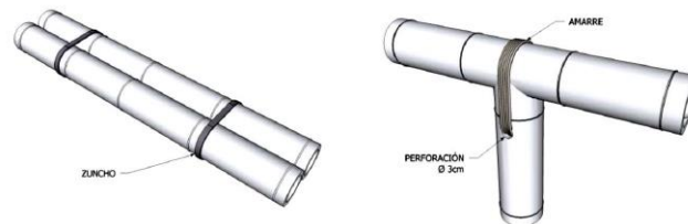
Figura 4. Uniones zunchadas o amarradas.
