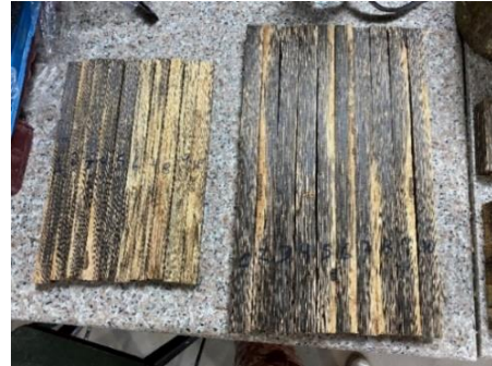
Figura 31. Probetas ensayadas a flexión.
