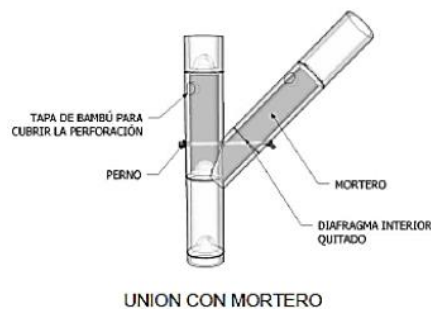
Figura 9. Unión con mortero Fuente:(Dávila Angulo, 2018)
