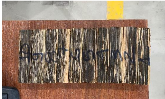
Figura 33. Muestras ensayadas a compresión perpendicular a la fibra. Fuente: Los Autores
