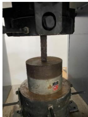
Figura 32. Ensayo a compresión paralela a las fibras.
