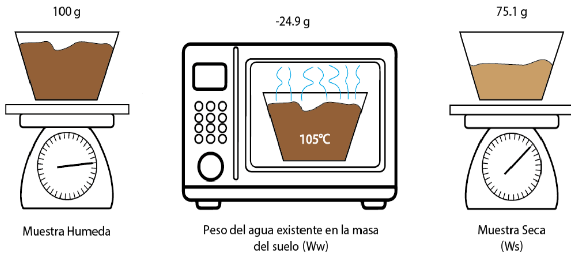
Figura 14: Esquema básico del método gravimétrico de medición de humedad del suelo.
