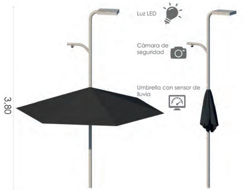
FIGURA 4.90: Luminaria con sensor, pantalla digital y cámara de seguridad. Fuente y elaboración: Propia
