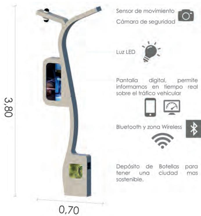
FIGURA 4.88: Luminaria con sensor, pantalla digital y cámara de seguridad. Fuente y elaboración: Propia
