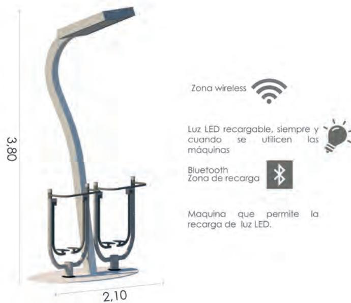
FIGURA 4.87: Luminaria con maquinaria generadora de energía eléctrica. Fuente y elaboración: Propia
