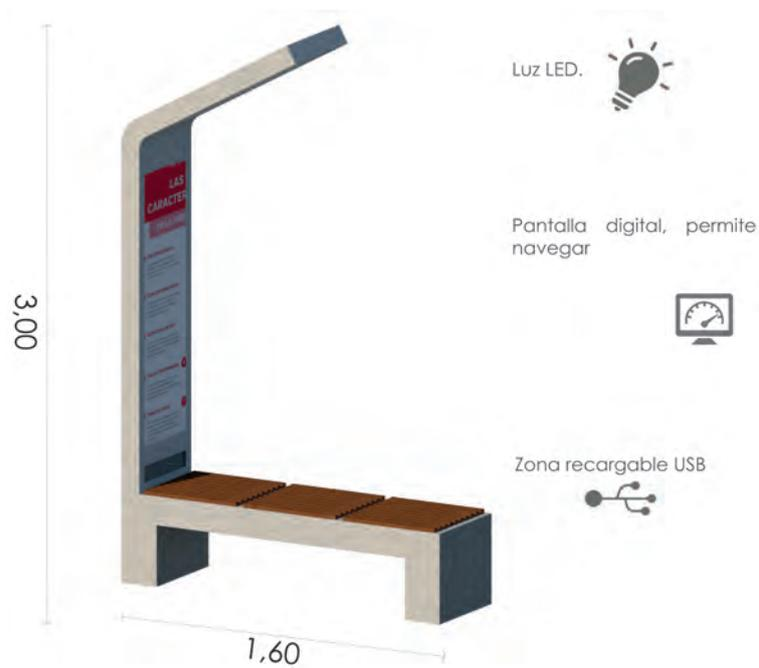
FIGURA 4.91: Silla con fuente de energía y pantalla digital. Fuente y elaboración: Propia
