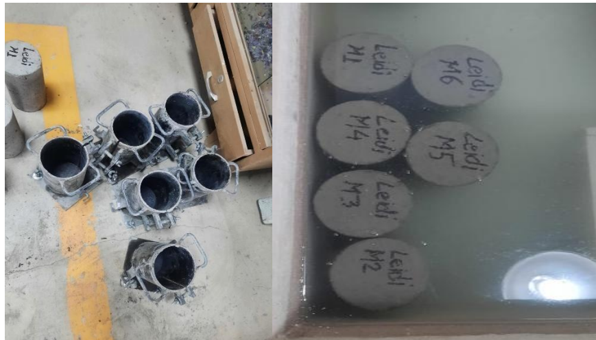
Desencofrado de los cilindros.
