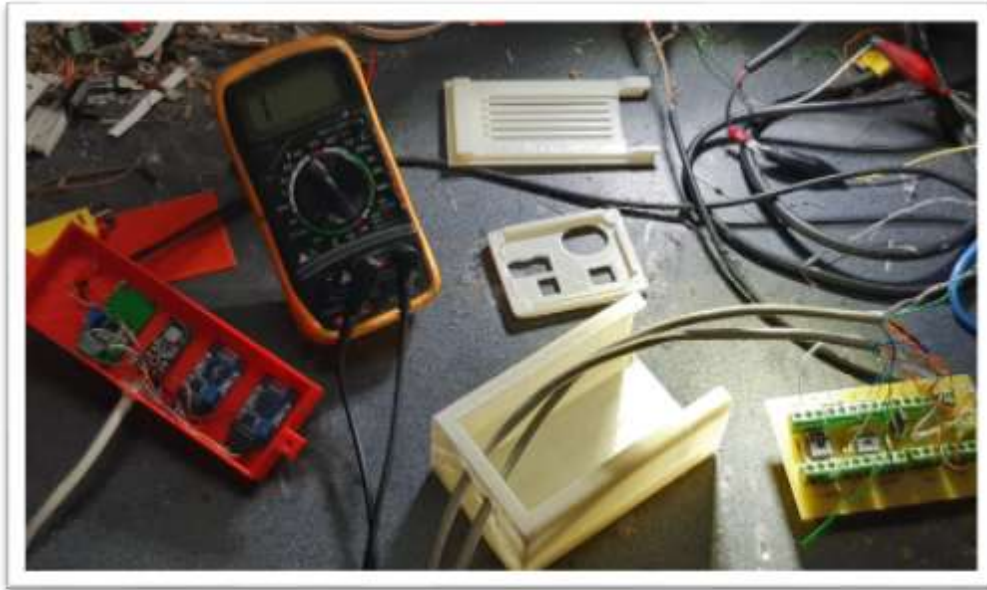
Figura 39 Elaboración de las cajas de sensores y arduino con su placa. Fuente: Elaboración propia.
