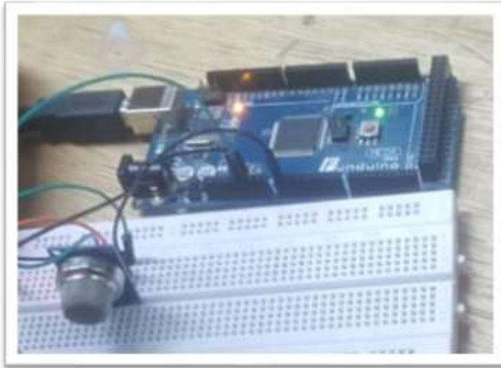
Figura 19 Pruebas del sensor MQ135 en aire limpio.
