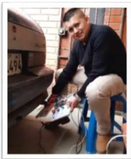
Figura 15 Pruebas del sensor MG811 con la presencia de CO 2 en la salida del escape. Fuente: Elaboración propia.
