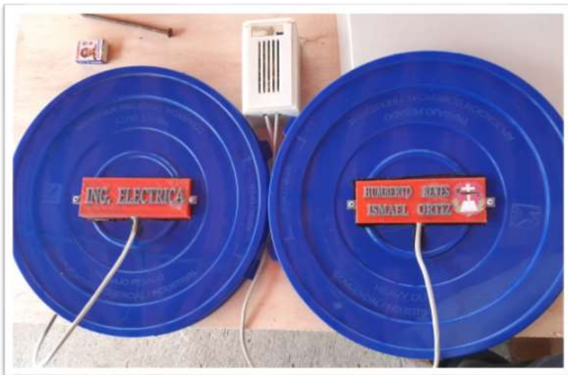
Figura 40 Montaje final de los sensores en sus respectivas tapas y sus conexiones a la placa Arduino. Fuente: Elaboración propia.
