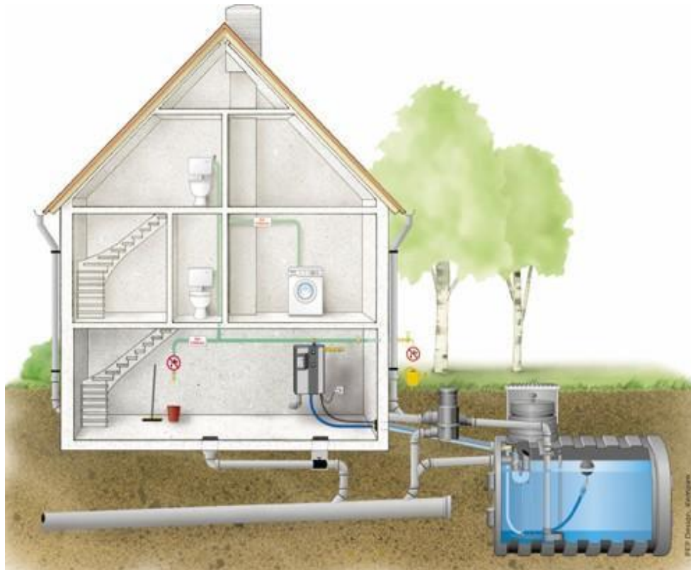
Fig. 10 Almacenamiento de Agua Lluvia
