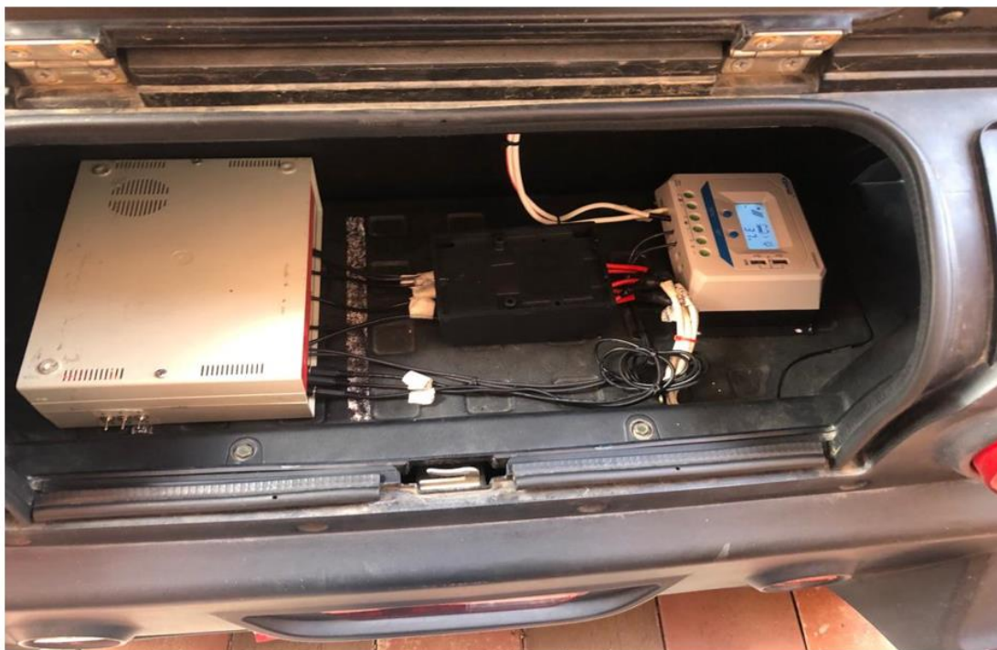
Ilustración 64. Circuito de carga mediante panel fotovoltaico.
