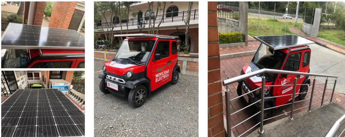
Ilustración 55. Panel solar fotovoltaico ubicado en el VE (UCACUE).
