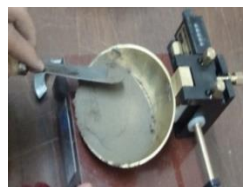
Fig 25: Colocación de la Muestra en la Copa de Casagrande
