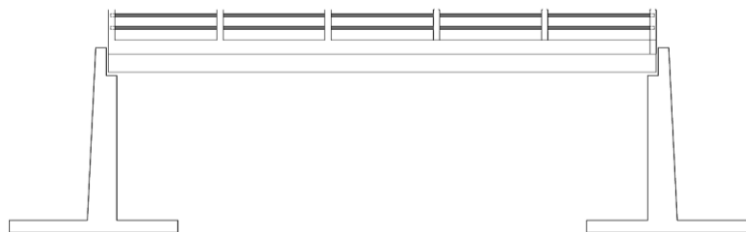
Fig 12: Sección Longitudinal Del Puente Propuesto
