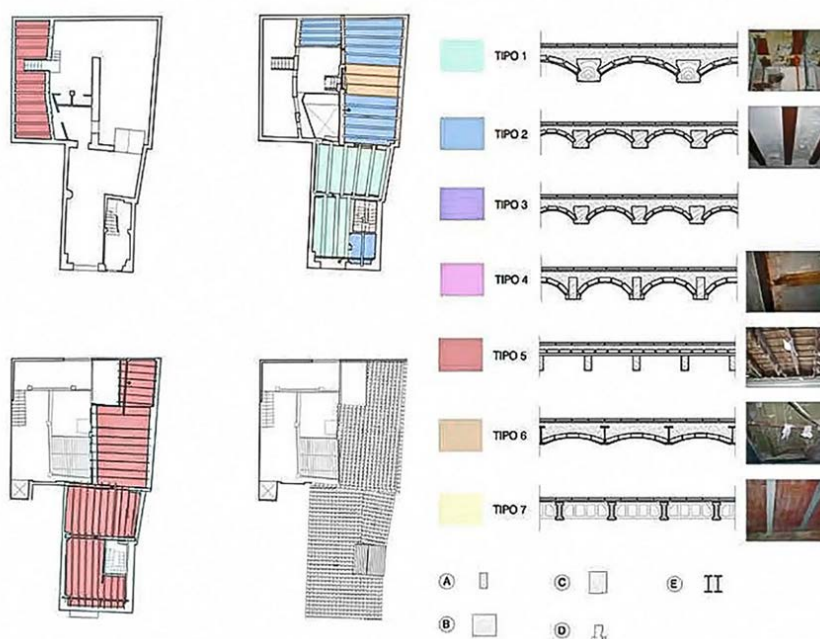
FIGURA 1.1: Plano de cielorrasos del edificio de viviendas Calle Maldonado 33, Valencia (España). Fuente y elaboración: Mileto y Vegas (2019) .
