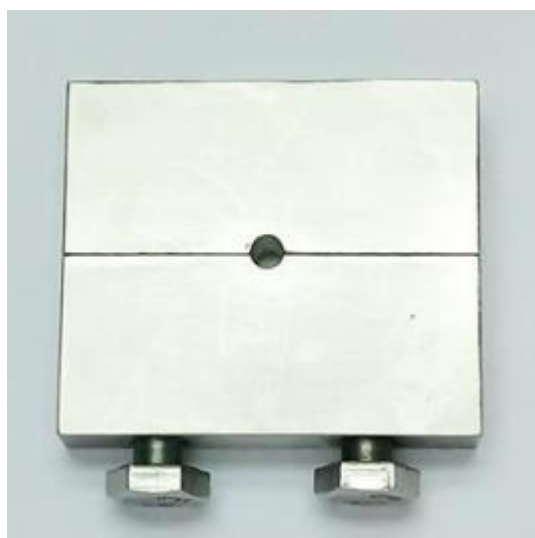
Figura 9: Matriz metálica de acero inoxidable, ISO 4049.
