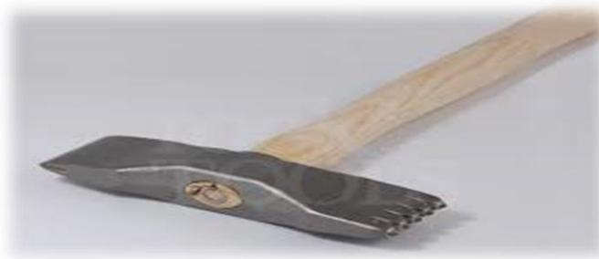
**Ilustración 12:** Martillo trinchante
