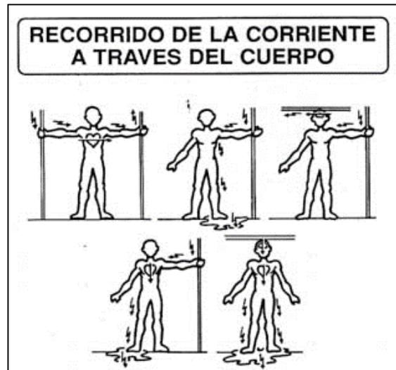
Fig. 3. Recorrido de la corriente a través del cuerpo humano
