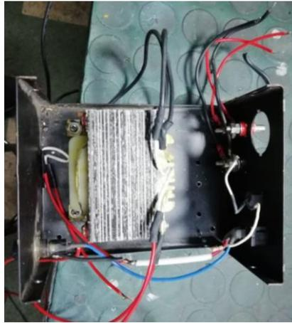
*Ilustración 10 Transformador y caja metálica para fuentes poder
