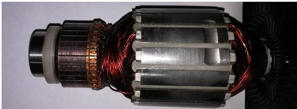
*Ilustración 19: Paso de bobinado para rotor.
