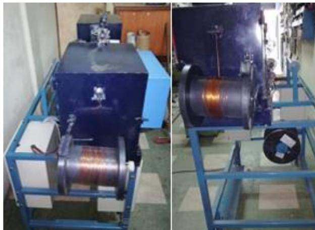
*Ilustración 21 Carga de alambre de cobre en carretes.
