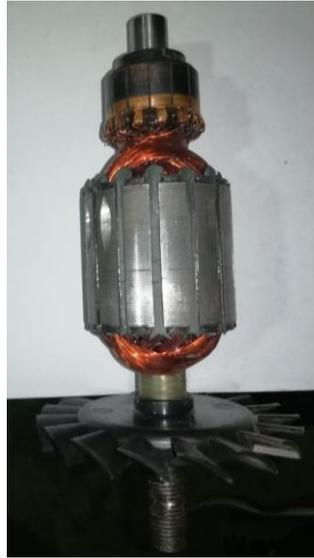
*Ilustración 24: Resultado final de bobinado de rotor en maquina bobinadora.
