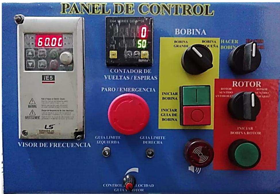
Ilustración 4 Panel de control con sus componentes de control.
