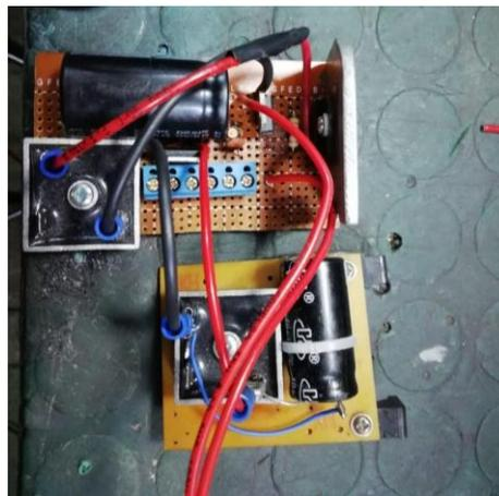
*Ilustración 11 Construcción de las fuentes de poder.
