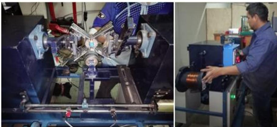
*Ilustración 23 Bobinado de rotor en maquina.
