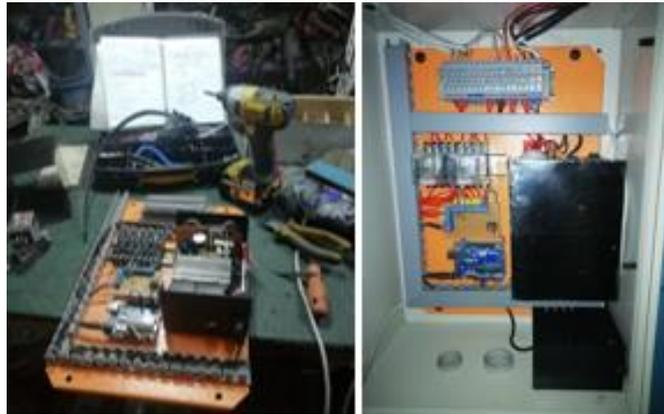
*Ilustración 15 Instalacion de componentes en tablero de control secundario.
