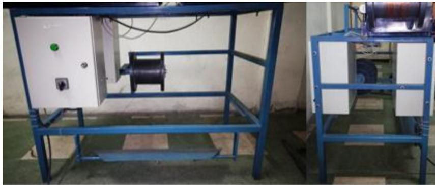
*Ilustración 3: Construcción de la estructura base para la bobinadora.
