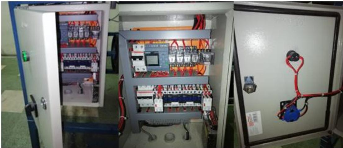
*Ilustración 9: Construcción del tablero de control con sus componentes electricos.
