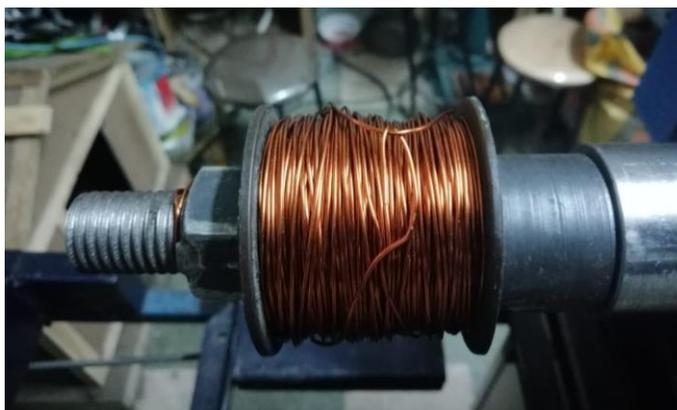
*Ilustración 28 Producto final de bobinado en carrete, no simétrico.
