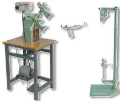
Figura 6. Bobinadora Semiautomática BMM79
