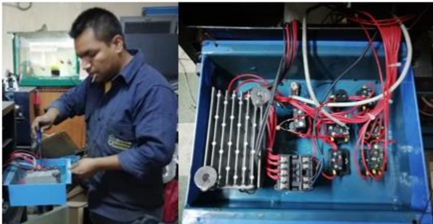
Ilustración 6: Conexiones eléctricas para el panel de control.
