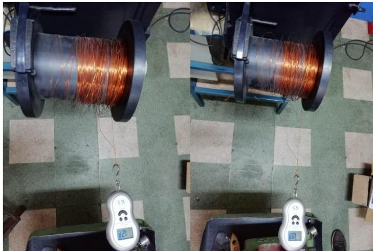
*Ilustración 16: Prueba de tensión en alambre de cobre con balanza de gancho
