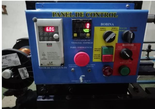
*Ilustración 25 Ingreso de numero de vueltas y velocidad en motores principales.
