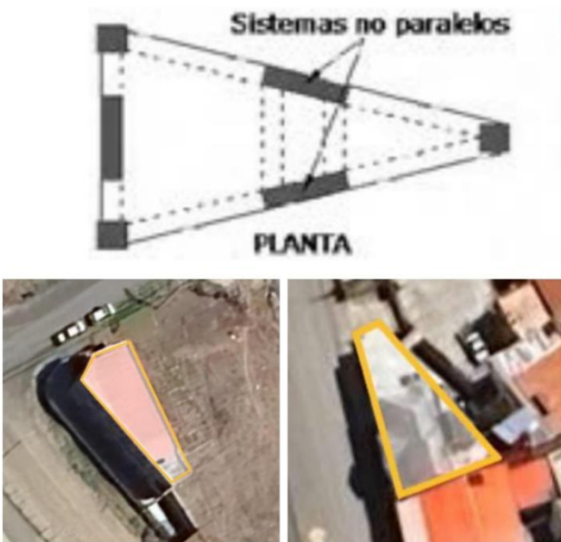
Fig. 13 Irregularidad en planta por ejes principales no paralelos.
