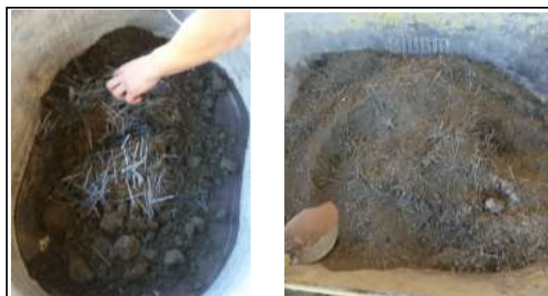
Figura 1. Mezclado de arena, cemento y agua con la fibra
