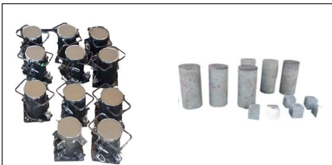
Figura 2. Vaciado y desencofrado de los morteros.
