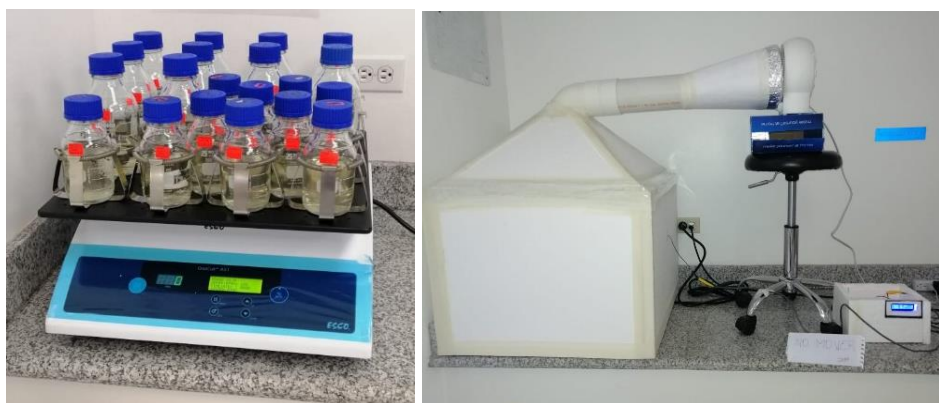
Figura 3: Shaker con muestras y mecanismo de incubación con sensor de temperatura
