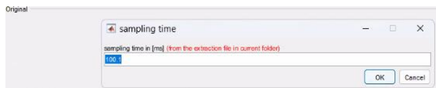
Figura 13 Definición del tiempo de muestreo (sampling time) para la conversión de velocidades en el software RIVeR (Fuente: Propia).
