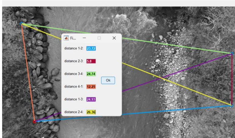
Figura 11 Ingreso de distancias reales entre puntos de control para la rectificación geométrica en el software RIVER (Fuente: Propia)
