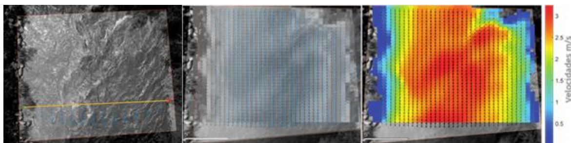
Figura 74 Sección de control (Lado Izquierdo), Campo de velocidad vectorial (Centro), y Campo de velocidad promedio (Lado Derecho) Yanuncay DJ Tarqui en m/s
