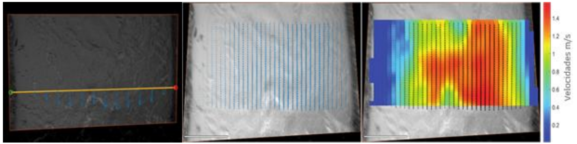
Figura 22 Sección de control (Lado Izquierdo), Campo de velocidad vectorial (Centro), y Campo de velocidad promedio (Lado derecho) Tarqui AJ Yanuncay en m/s
