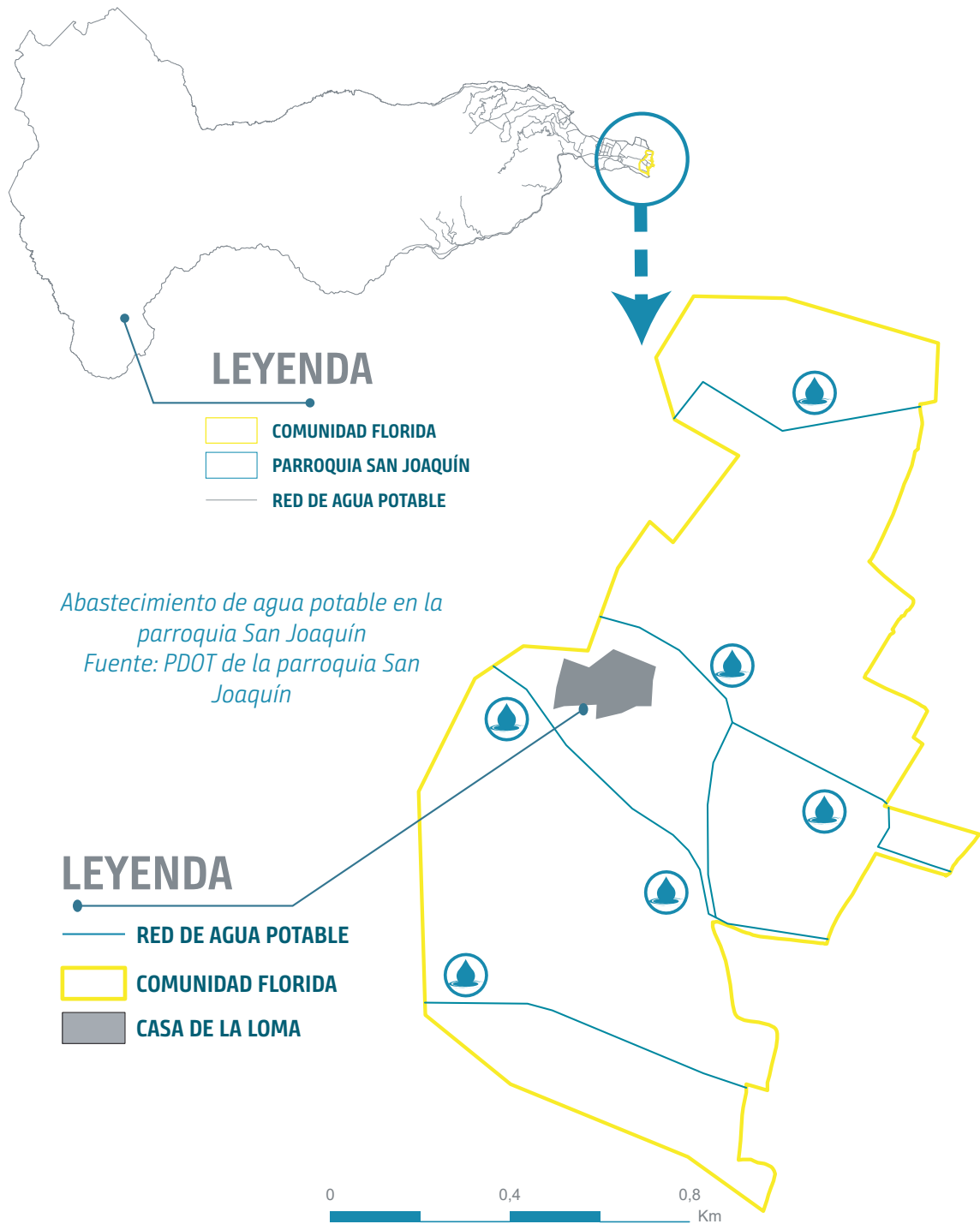
FIGURA 2.25: Red de agua potable en la comunidad Florida, Fuente: Elaboración propia
