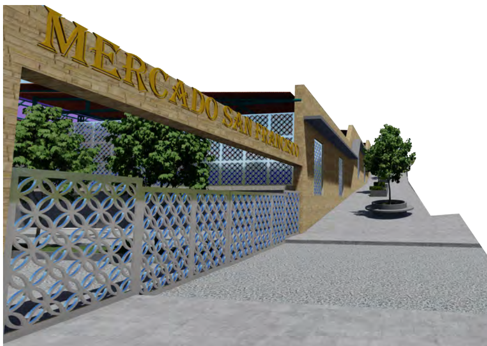
FIGURA 81: Fachada hacia la calle Atahualpa: se aprecia la nueva forma y materialidad de la fachada, el uso de la piedra como revestimiento, vidrio y acero en las ventanas; hormigón pulido en el alero superior del muro perimetral, nótese también la regeneración de la vereda conjuntamente al ingreso vehicular. Elaboración: El Autor
