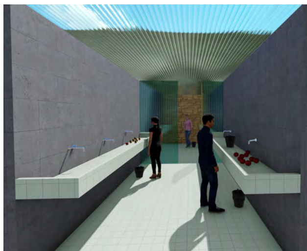
FIGURA 58: Lavaderos de alimentos; espacio destinado al lavado de frutas y verduras, es un lugar específico donde los comerciantes acuden para limpiar los productos que van a vender en sus puestos, este espacio se encuentra realizado por azulejos claros y una pequeña cubierta de PVC traslucido que permite tener un espacio claro y protegido. Elaboración: El Autor.
