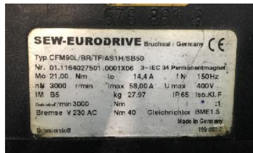
Fig. 2 Placa del servomotor
