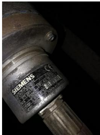
Fig. 5 Encoder incremental Fuente: Autor
