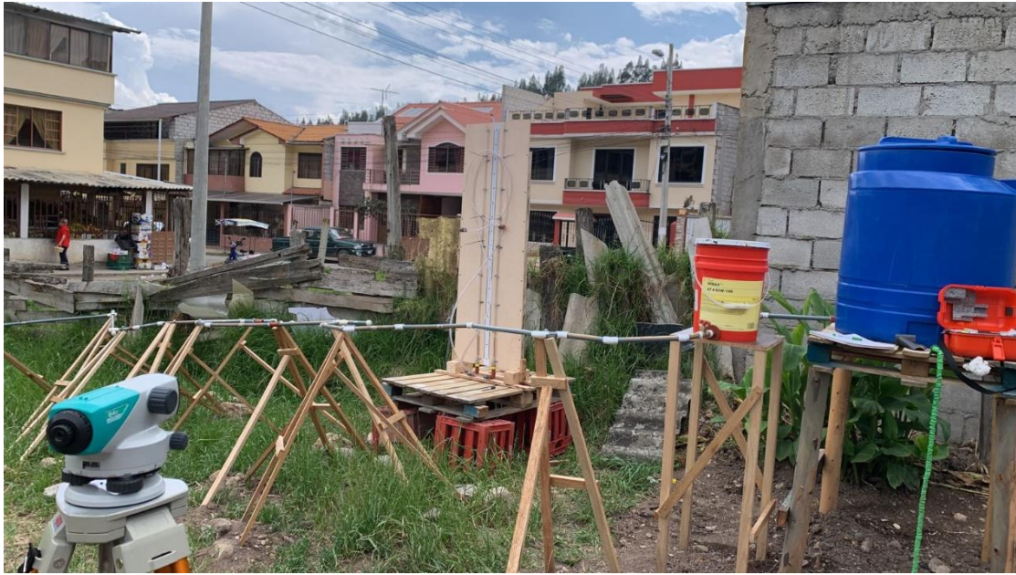
Figura 7.13: Nivelación de nodos del modelo. (Autores)
