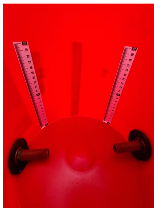
Figura 7.8: Calibración de la caneca. (Autores)
