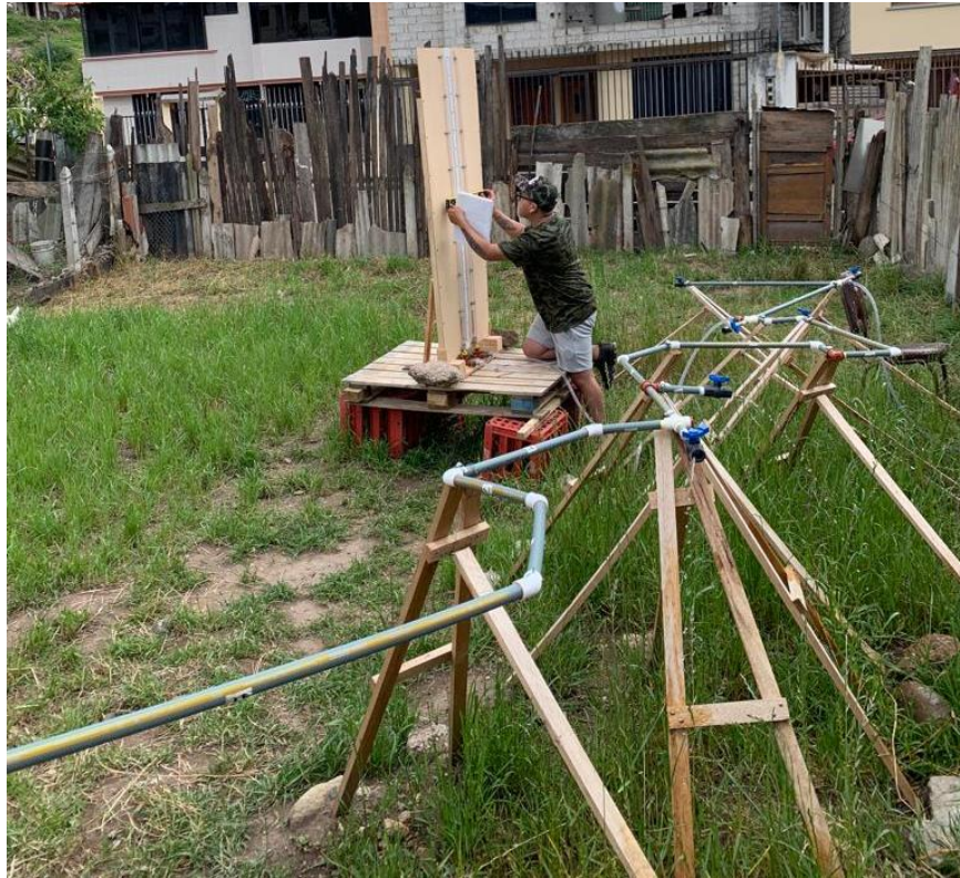
Figura 7.16: Medición de presiones en el modelo. (Autores)
