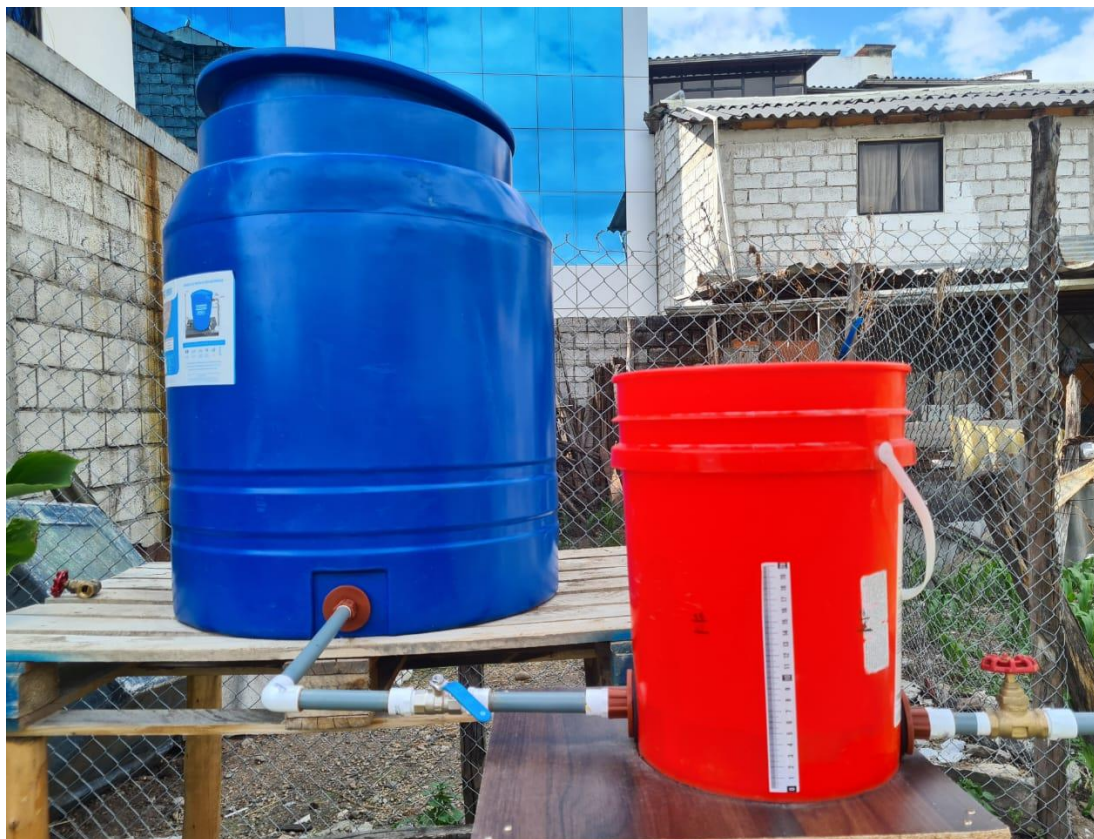
Figura 7.10: Conexión tanque - caneca - sistema. (Autores)
