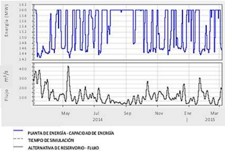
Figura. 57 Generación eléctrica del embalse Mazar con el máximo de operación propuesto
