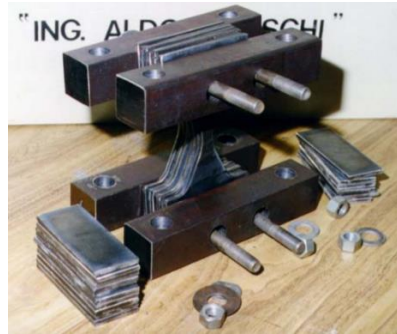
Figura 2.2 Modelo de un dispositivo ADAS (Almansa & Bozzo, 1998)
