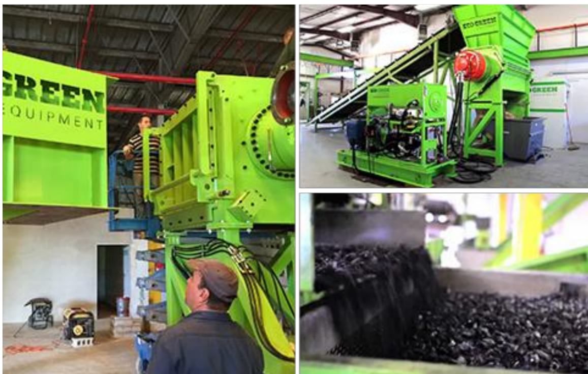
Ilustración 3: Proceso de trituración de NFU para la obtención de granulado de caucho.
