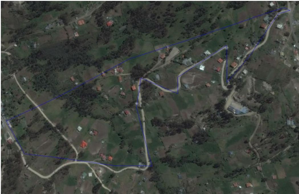
Figura 12. Poligonal Cerrada de la Vía Santísima Trinidad - Punta Corral.
