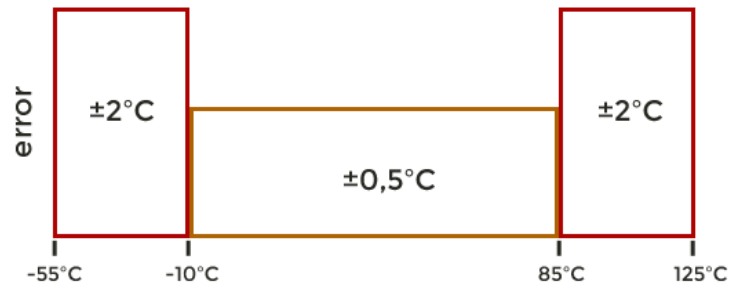
Figura 14. Margen de error de medición del sensor d18B20
