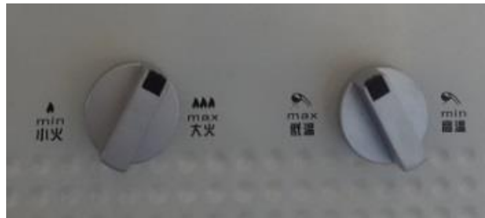
Ilustración 16. Perillas de paso de agua y de biogás.
