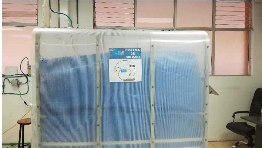
Figura 21. Crecimiento de bolsa de almacenamiento de gas
