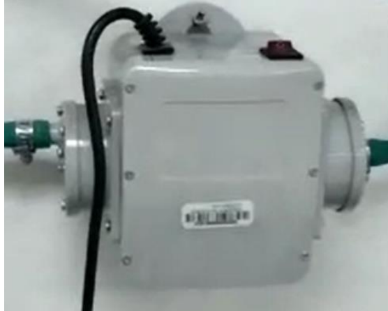
Ilustración 14. Generador de presión de biogás
