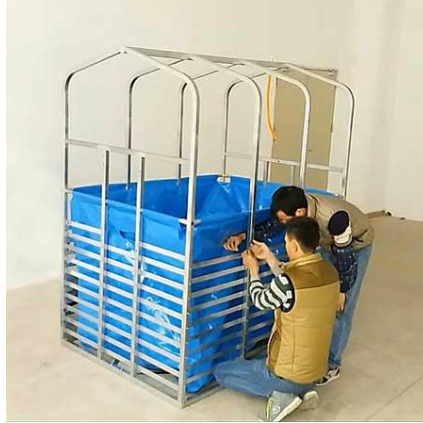
Figura 7. Ensamblado de sistema biodigestor. Fuente: (PUXIN, 2019)
