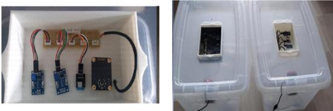
Figura 18: a) Sistema de armado de los sensores b) Sensores colocados en los biodigestores
