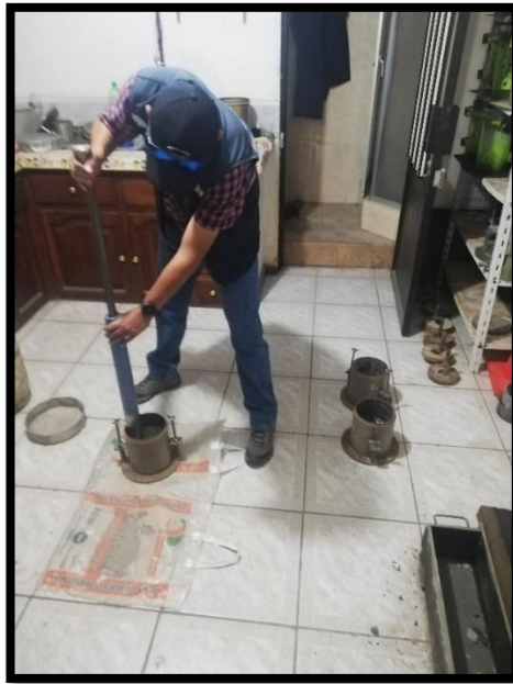
Foto N° 23 Compactación de materiales. Fuente: Christian Romero, Cuenca, 2020.
