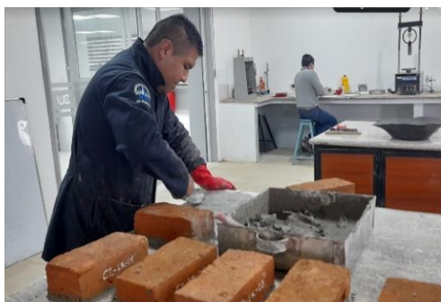
Figura 39: Rectificación de ladrillos. Fuente: (Propia)
