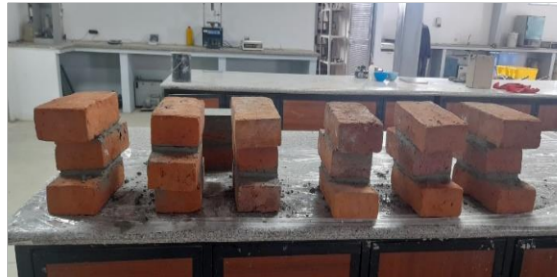
Figura 42: Elaboración de los especímenes tipo tríos. Fuente: (Propia)
