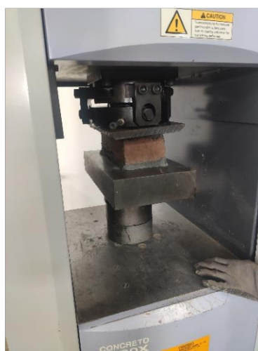
Figura 40: Ensayo a compresión del ladrillo. Fuente: (Propia)
