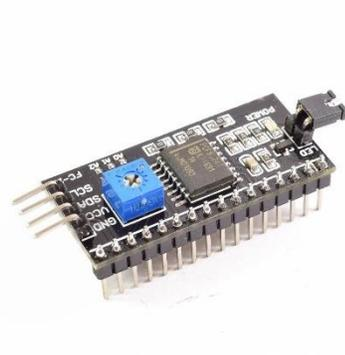
*Ilustración 4 Módulo I2C Fuente: (geekbotoelectronics.com, s.f.)*
