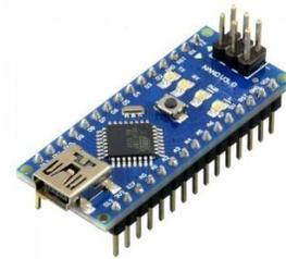
*Ilustración 1 Arduino NanoV3 Fuente: (ja-bots.com, s.f.)*
