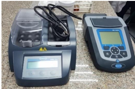
Anexo 7. Equipos para determinar la DQO
