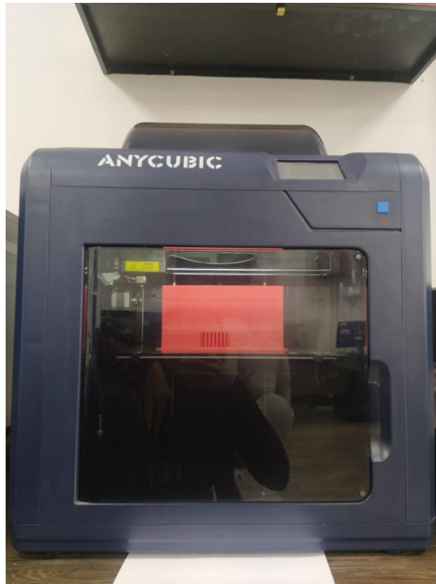
Figura 49. Impresión de las estaciones móviles en una impresora 3D.
