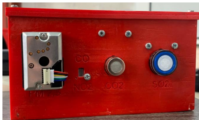
Figura 12. Estación móvil para el monitoreo en el vehículo a combustión.
