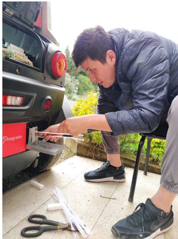
Figura 54. Colocación de soporte para estación móvil.
