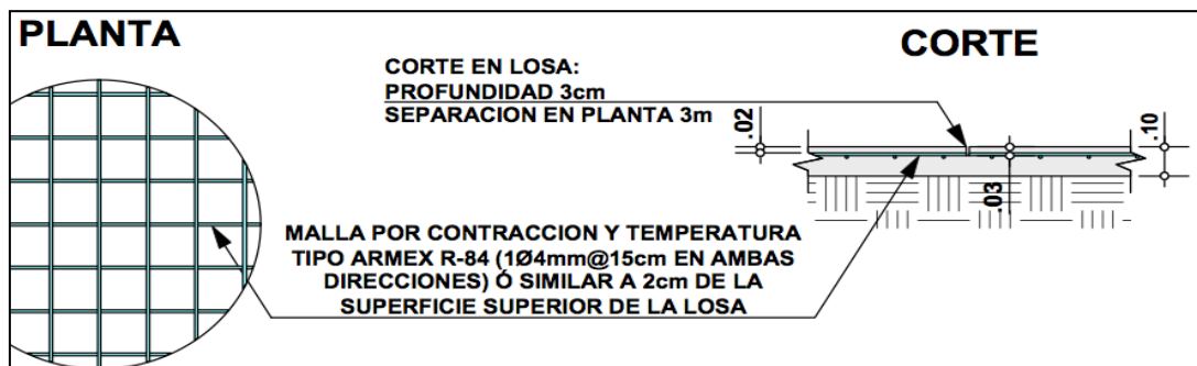
Imagen 100: Detalle Losa de Contrapiso
