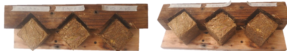
Desencofrado de muestras
