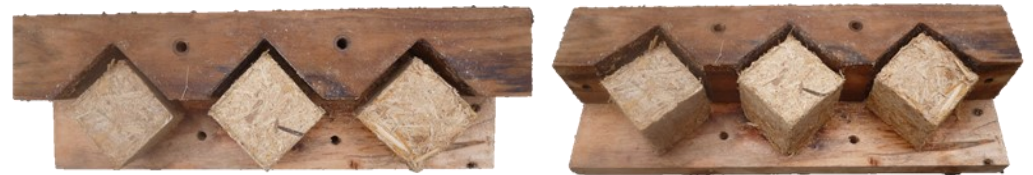
Desencofrado de muestras
