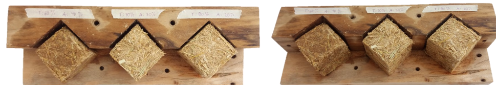
Desencofrado de muestras
