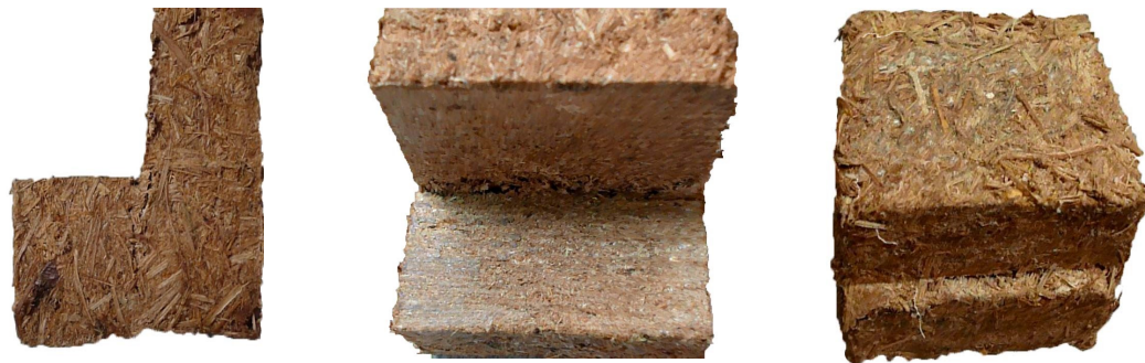
Fotografía 28: Fracturas de corte en las probetas. Fuente: Propia.
