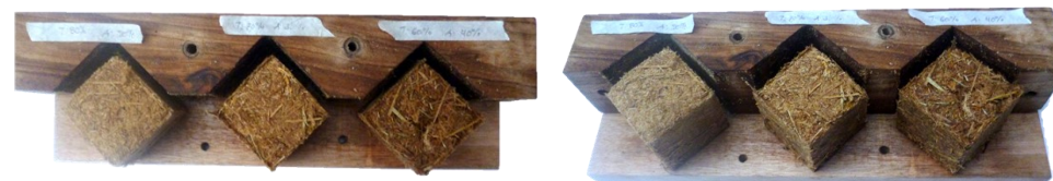
Desencofrado de muestras
