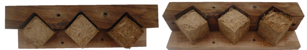
Desencofrado de muestras
