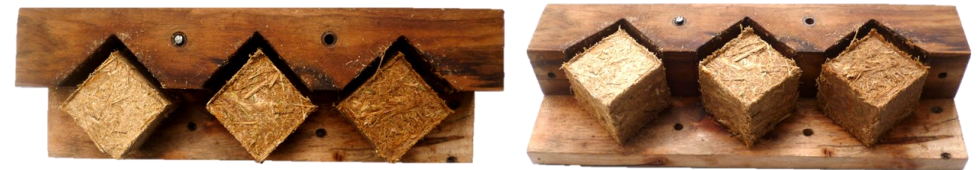
Desencofrado de muestras
