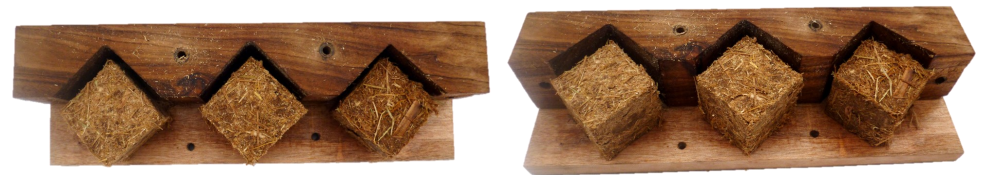
Desencofrado de muestras
