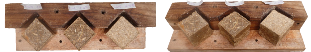
Desencofrado de muestras
