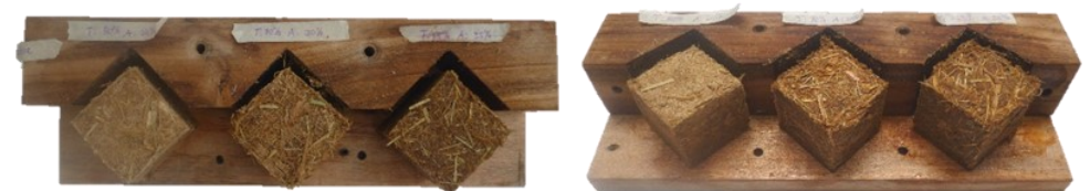
Desencofrado de muestras
