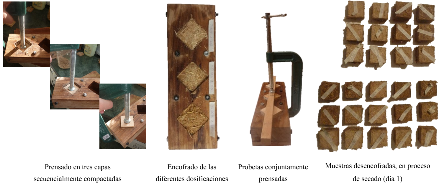
Fotografía 3: Pasos de prensado, encofrado , desencofrado y secado de muestras.
