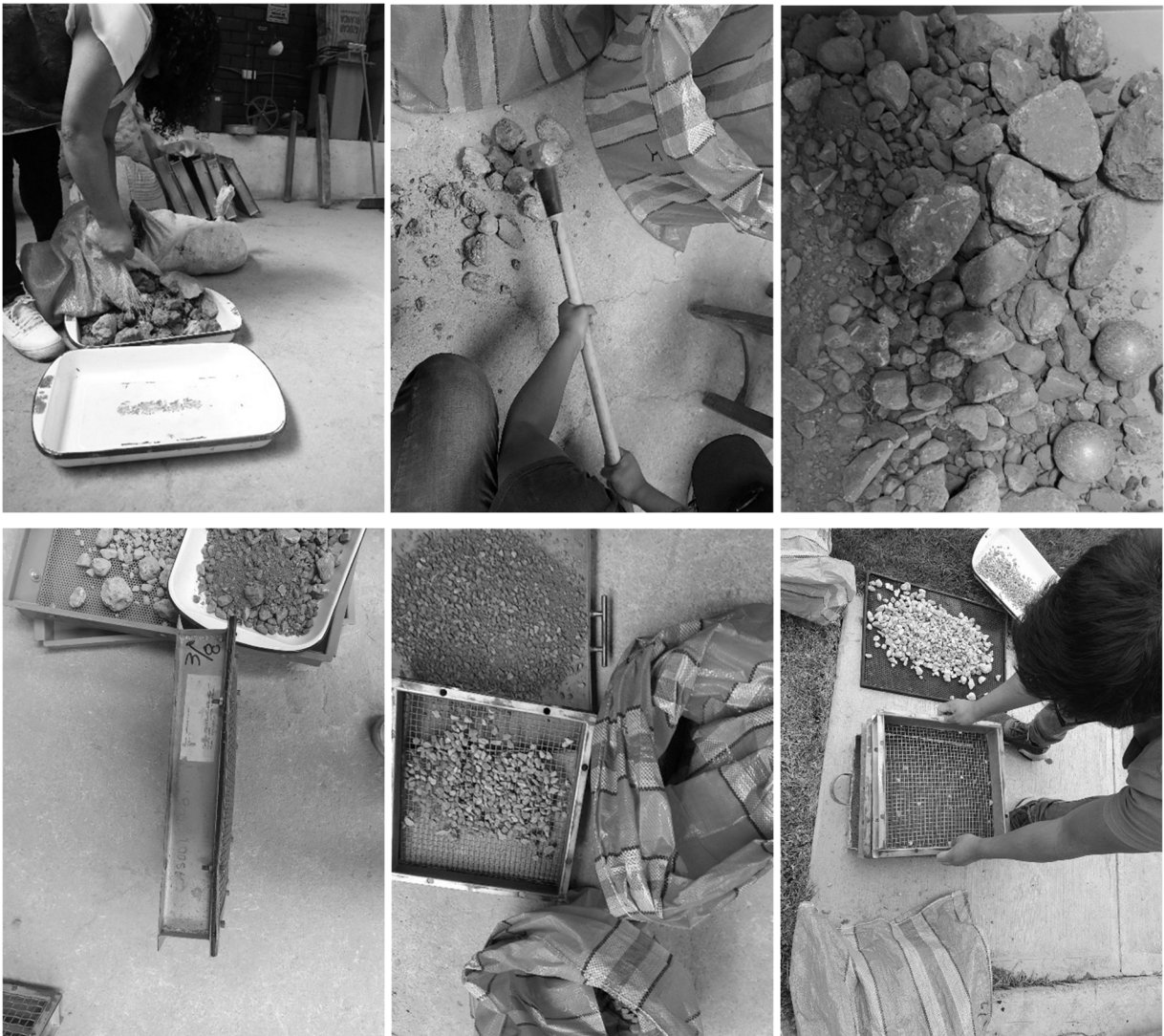
Figura 24: Proceso de triturado para la obtención de RCD
