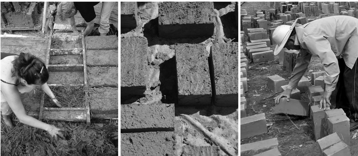
Figura 7: Fases del proceso de producción del adobe
