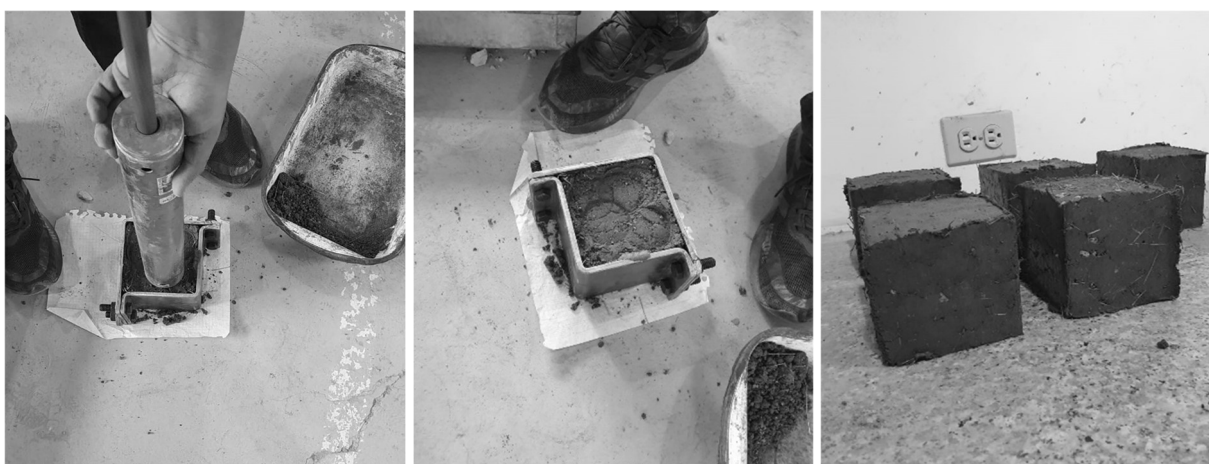
Figura 40: Elaboración de muestras cúbicas
