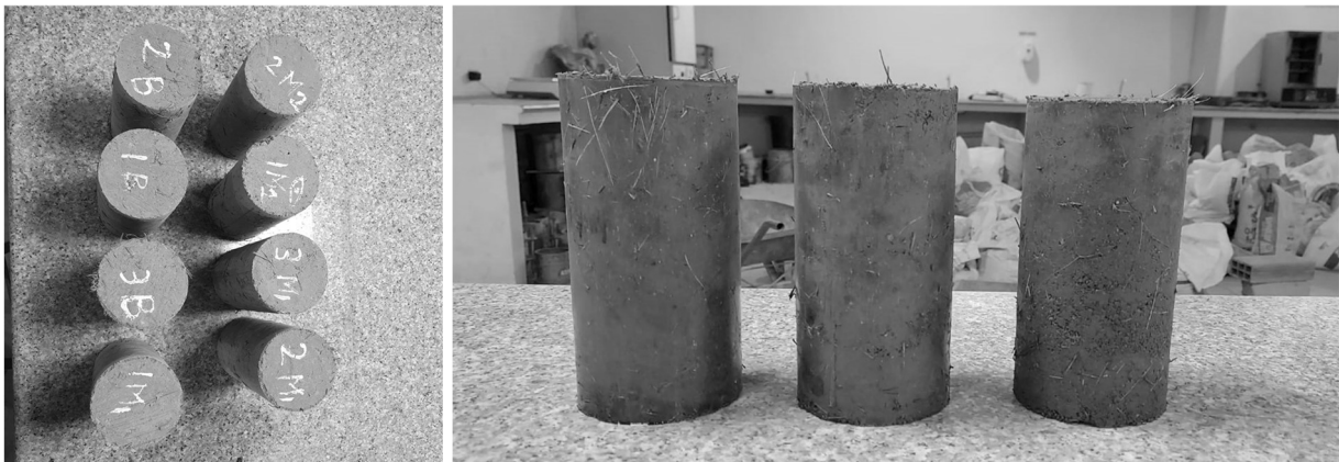
Figura 50: Muestras cilíndricas para ensayos de resistencia a la tracción indirecta por compresión diametral
