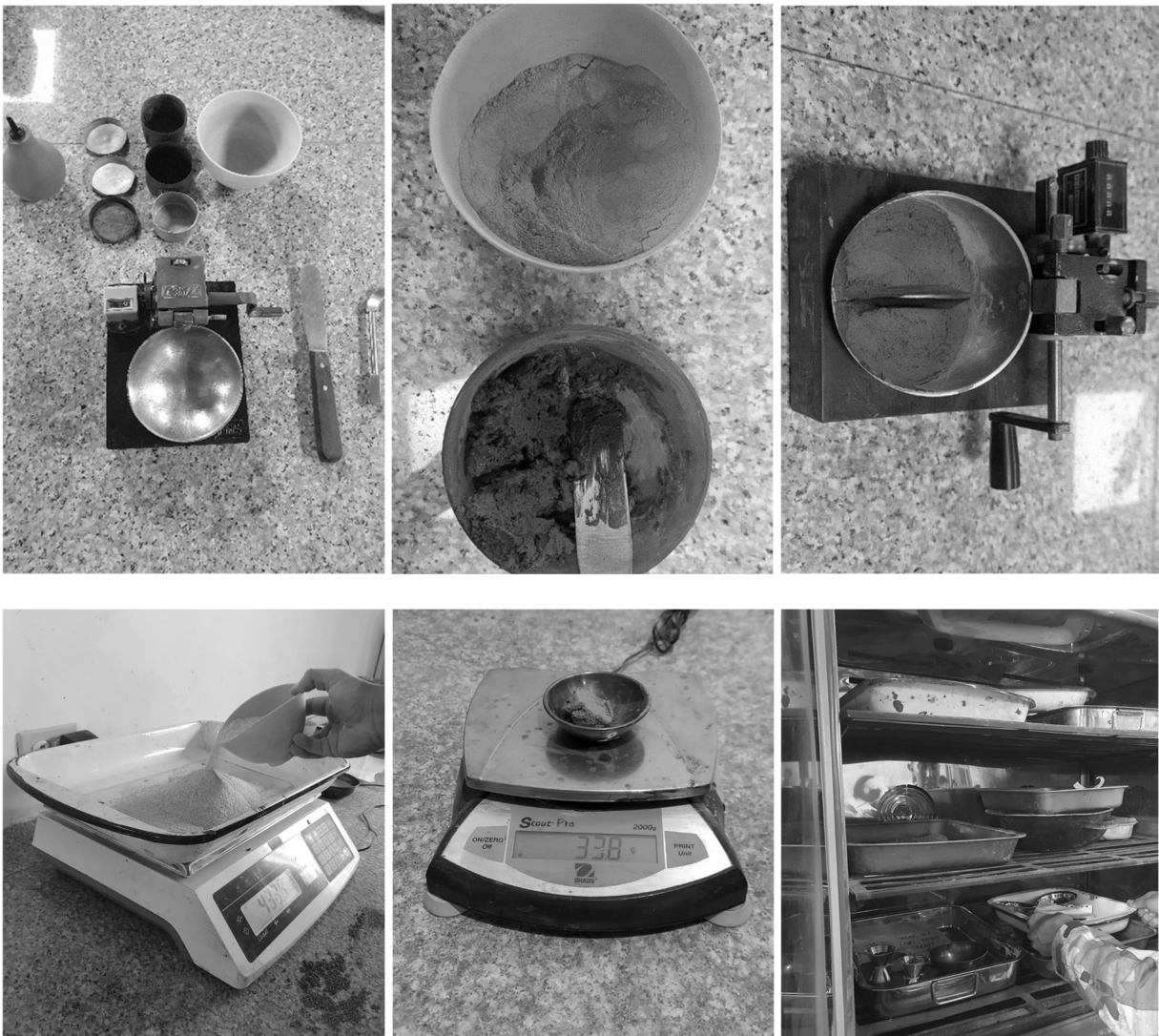
Figura 32: Procedimiento del límite líquido
