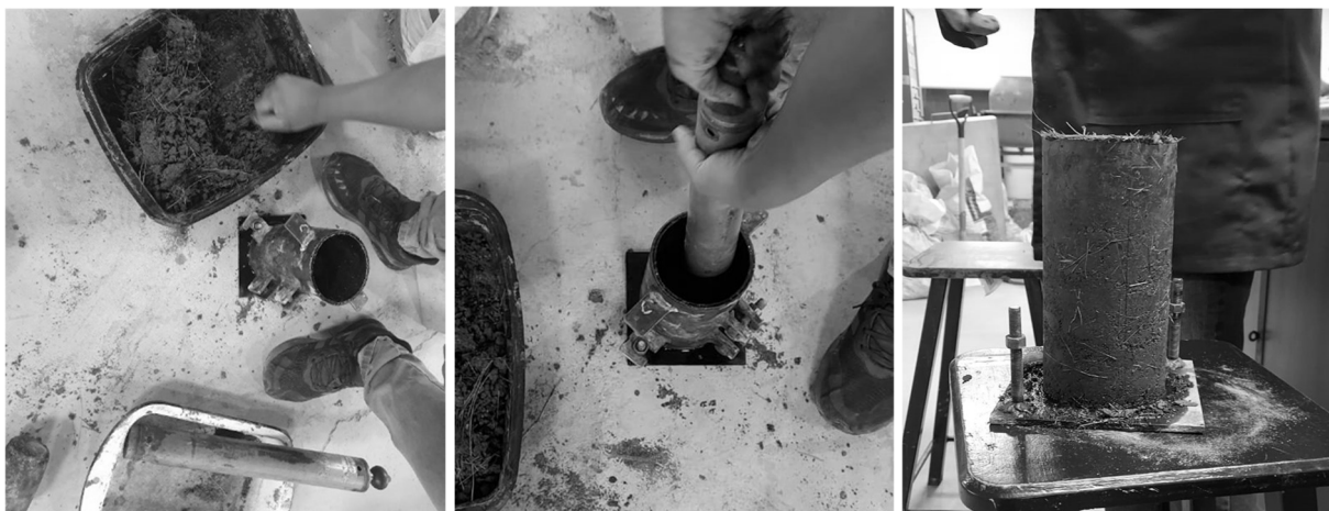
Figura 41: Elaboración de muestras cilíndricas
