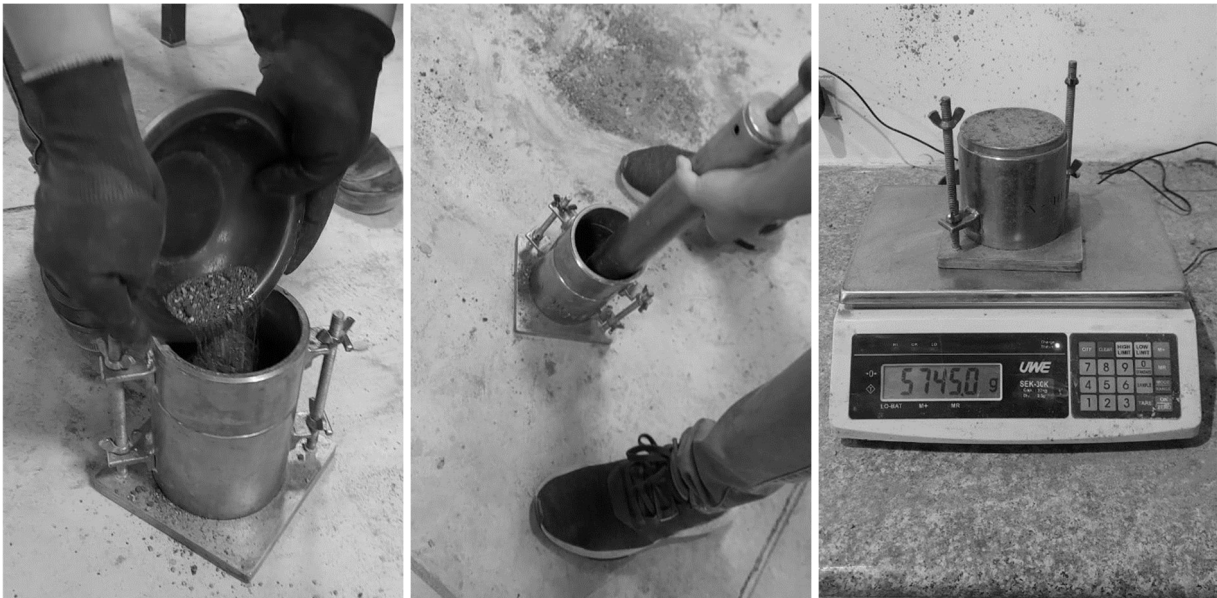
Figura 35: Procedimiento del ensayo de Proctor estándar
