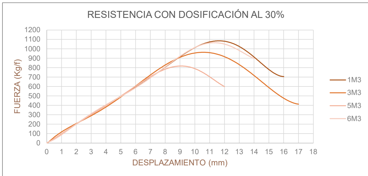
Gráfica 14 Resumen del ensayo de resistencia a la compresión con dosificación al 30% de RCD
