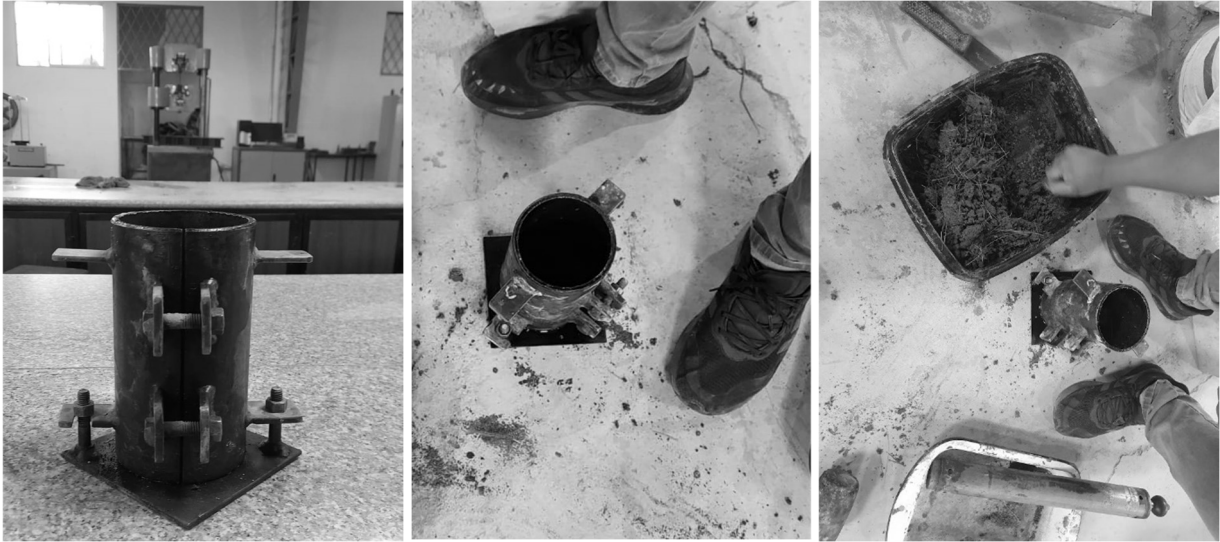
Figura 37: Encofrado cilíndrico metálico
