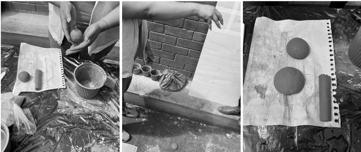
Figura 30: Ensayo de caída de bola
