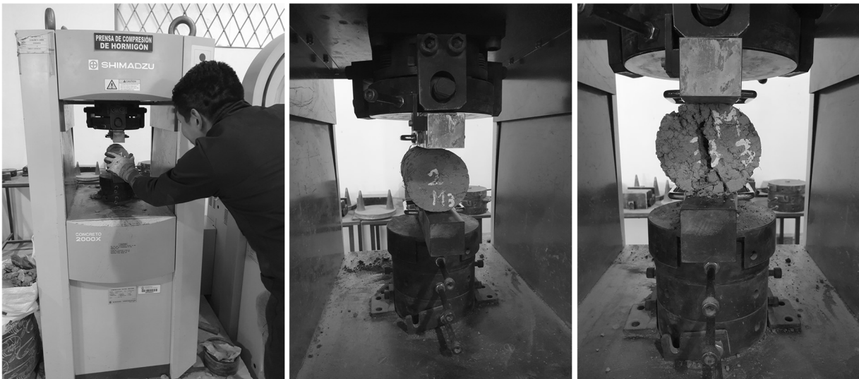
Figura 54: Ensayo de resistencia a la tracción indirecta por compresión diametral con la dosificación al 30% de RCD
