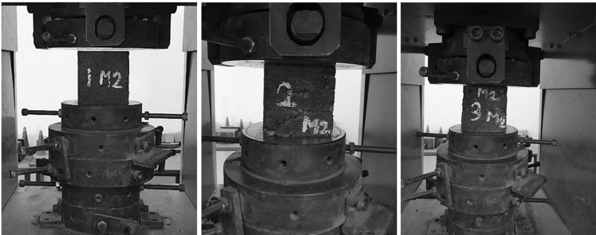
Figura 47: Ensayo de resistencia a la compresión con la dosificación al 20% de RCD
