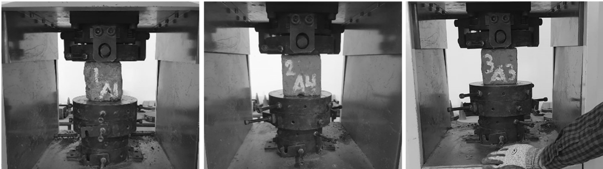
Figura 45: Ensayo de resistencia a la compresión - Adoberas
