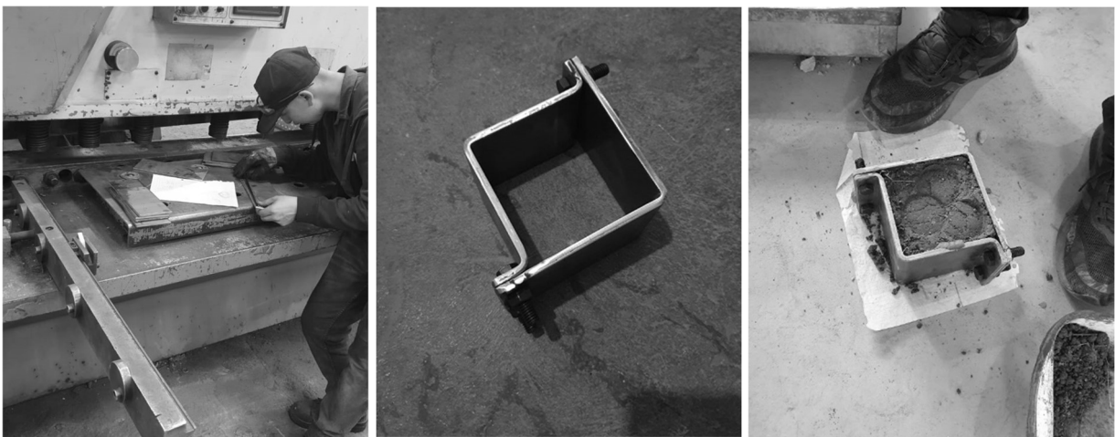
Figura 36: Encofrado cúbico metálico
