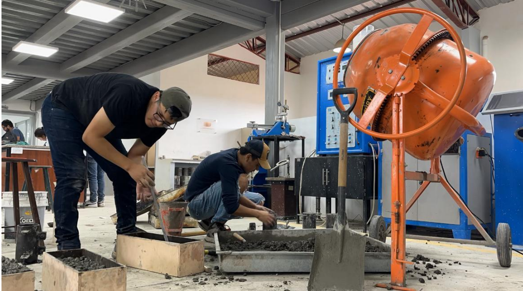
Elaboración de vigas de hormigón.
