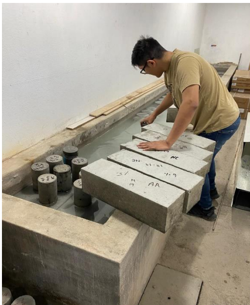
Curado de vigas de hormigón
