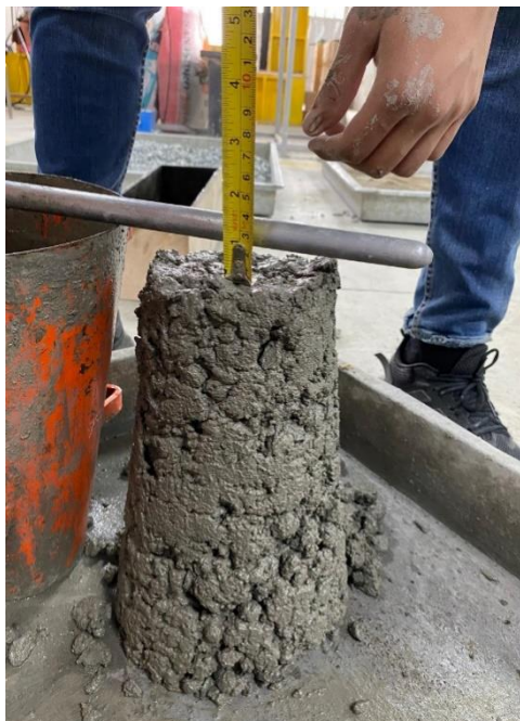
Revenimiento del hormigón.
