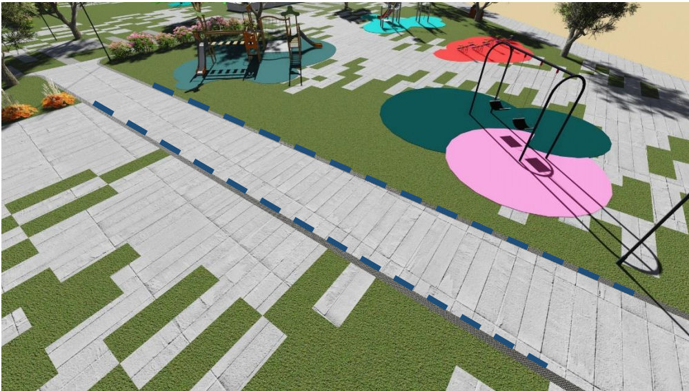
Figura 152: canales de recolección de agua lluvia, Parque Barrial, Virgenpamba, Azogues, Ecuador. [Ilustración]. “Elaboración Propia”
