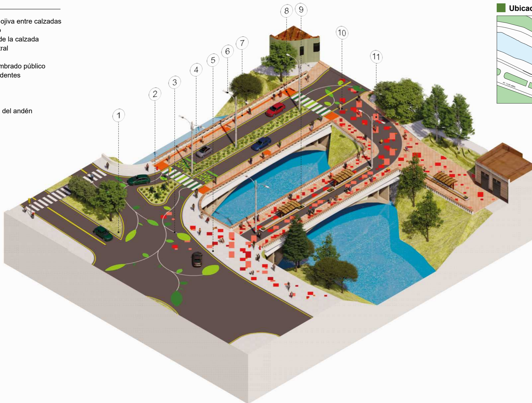
Figura 4.13: Implementación de un puente paralelo y peatonización del antiguo puente Centenario. Fuente y elaboración: Propia.
