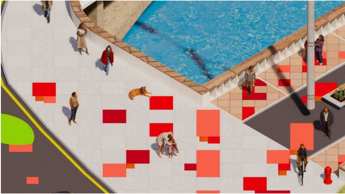
Figura 5.13: Aplicación del urbanismo táctico y la elevación de la antigua calzada a nivel del andén para armonizar el espacio y que la ciudadanía camine sin barreras. Fuente y elaboración: Propia.
