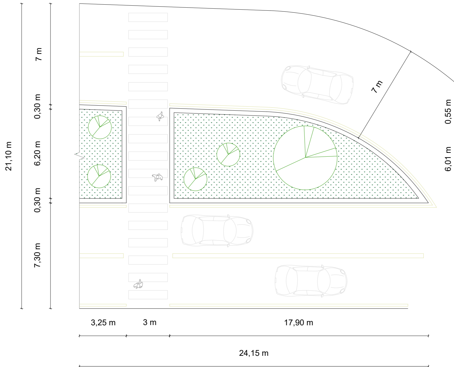
Figura 4.14: Trazado en planta del cruce a media ojiva propuesto. Fuente y elaboración: Propia.
