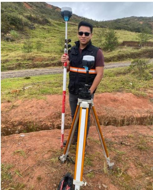
**Figura 7:** Sistema Leica RTK GNSS Base y Leica GNSS Rover
