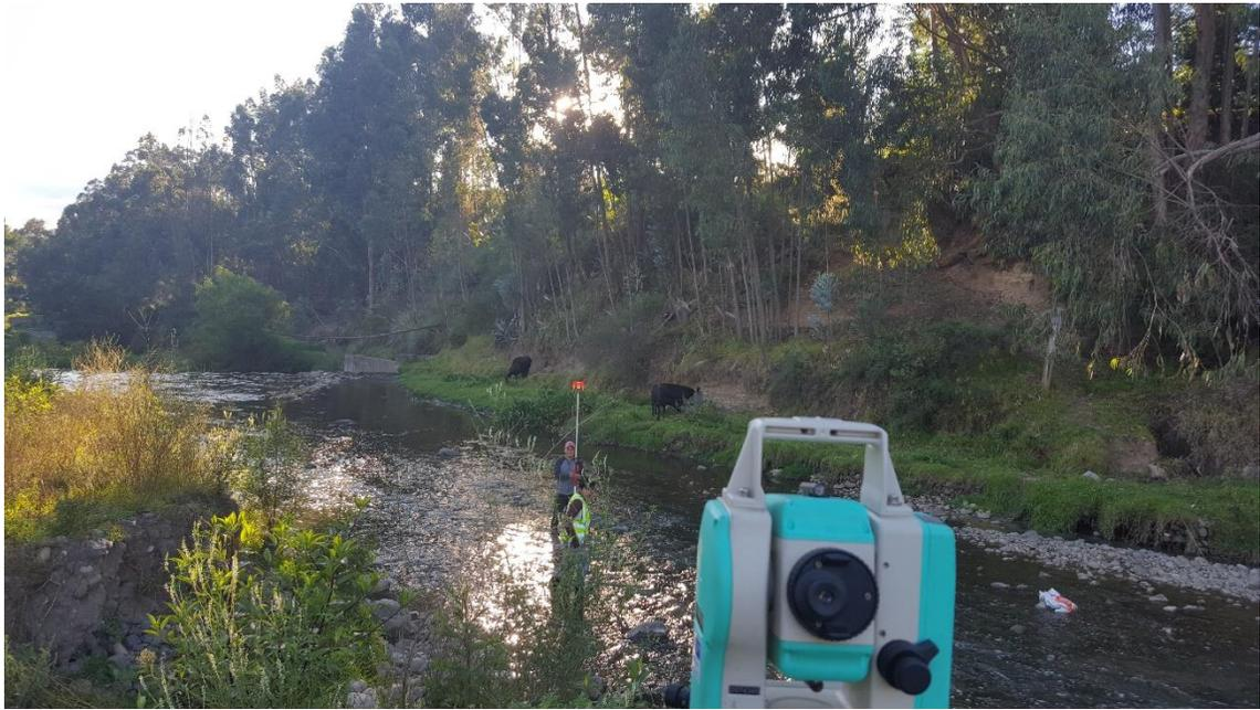
Se realizó el levantamiento topográfico a 100 metros a la redonda de cada posible torre a ser colocada.
