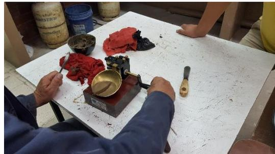
Ensayo cuchara de casa grande para determinar el limite liquido
