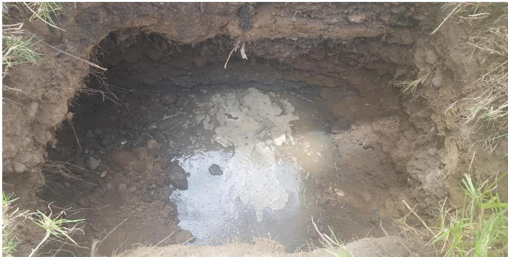
Tiene una capa de material vegetal de 30 cm, y debajo de esta capa se encontró la presencia de material (grava y arena) color gris claro con un 30% de material mayor a 3”.
