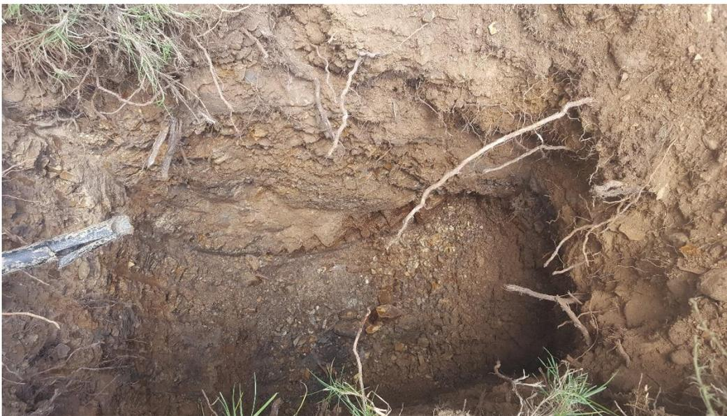
Tiene una capa de material vegetal de 50 cm, y debajo de esta capa se encontró la presencia de material arcilloso color amarillo
