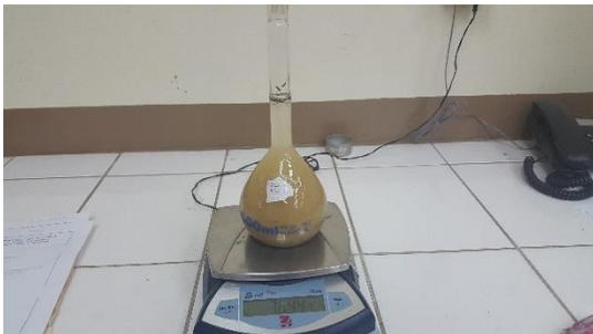
Determinación del peso específico de solidos del suelo por medio del picnómetro
