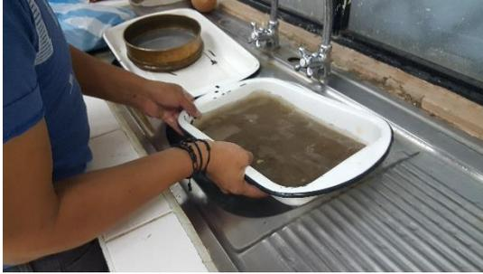
Lavado de la muestra para el ensayo granulométrico
