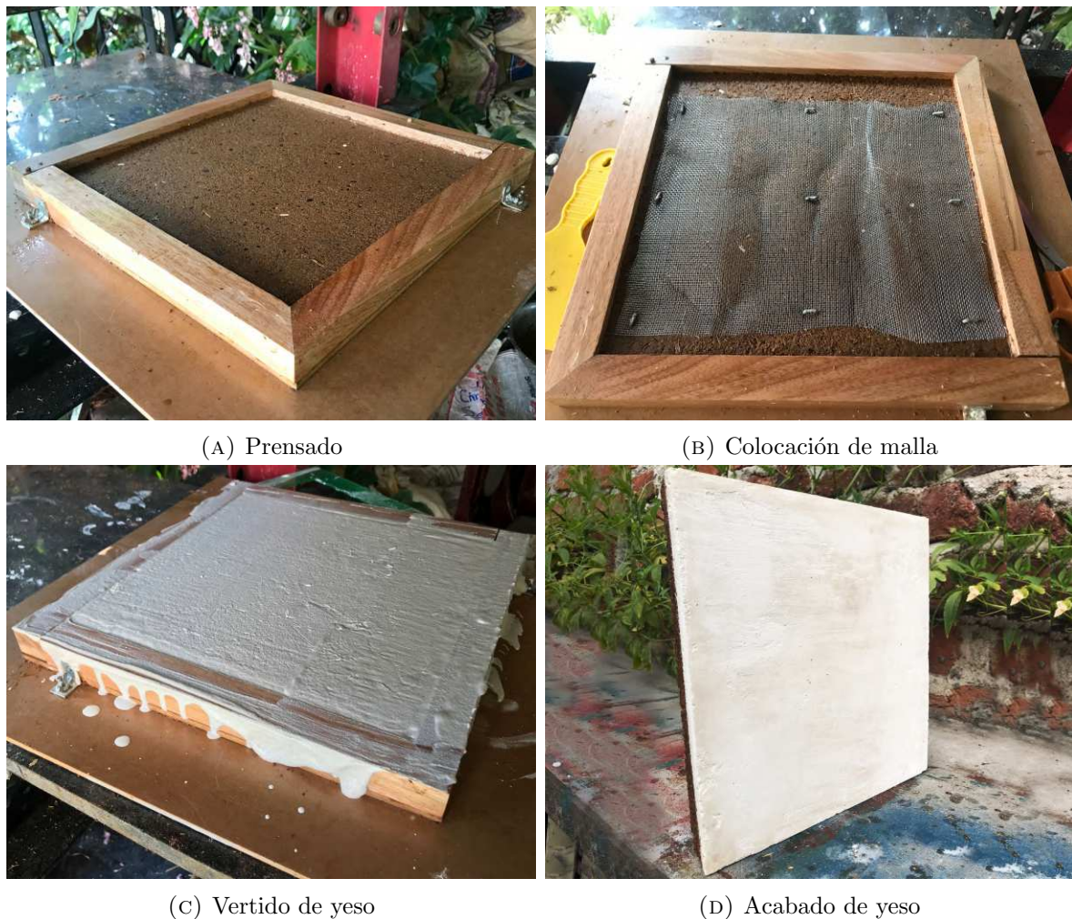
FIGURA 3.5: Proceso de elaboración de capa de yeso. Fuente: autor
