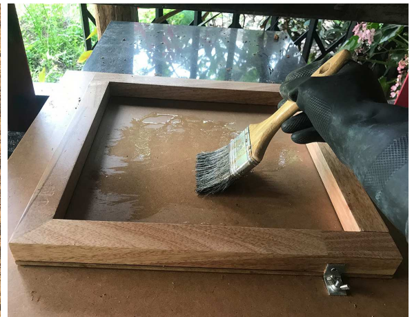
(B) Aplicación de desmoldante
