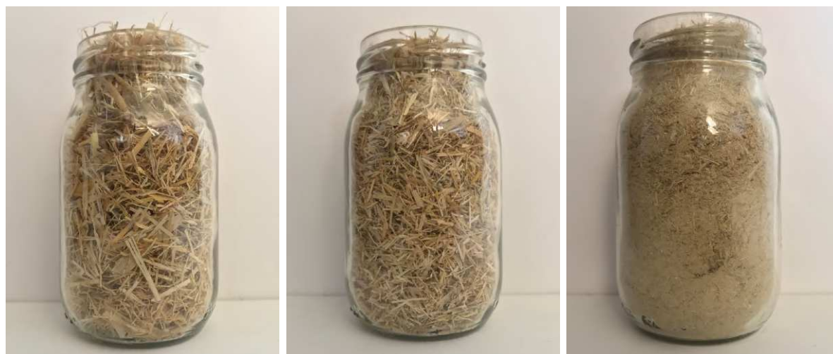
(A) Fragmentos 4\text{mm} \geq 10\text{mm} (B) Fragmentos 2\text{mm} \geq 4\text{mm} . (C) Fragmentos \geq 2\text{mm} .
