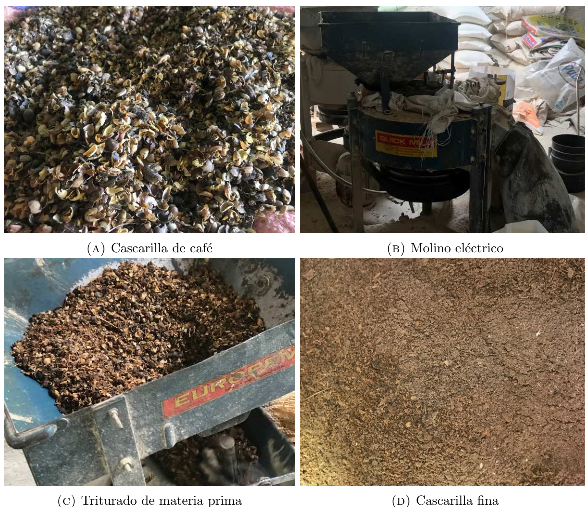
FIGURA 2.2: Proceso de trituración de la cascarilla. Fuente: autor
