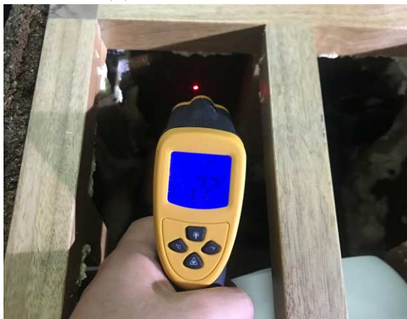
(E) Temperatura superficie interior
