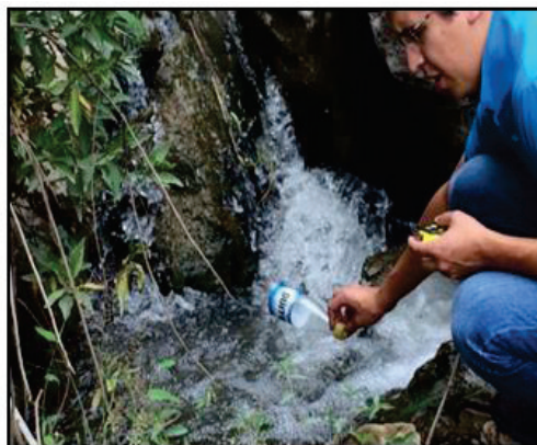
Colocando elemento a flote
