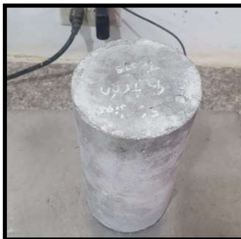
Figura 16. Desencofrado del espécimen.
