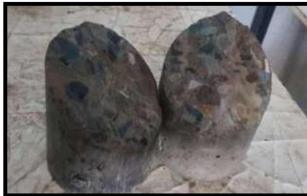
Figura 18. Corte del espécimen a 30°.
