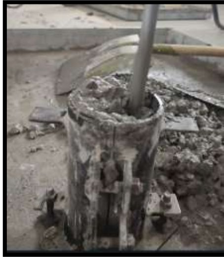
Figura 15. Varillado de mezcla en los moldes correspondientes.
