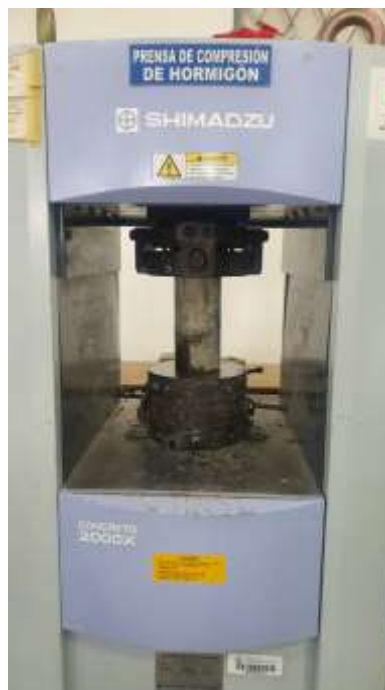
Figura 22. Ensayos a compresión (Máquina de compresión). Fuente: Elaboración propia.
