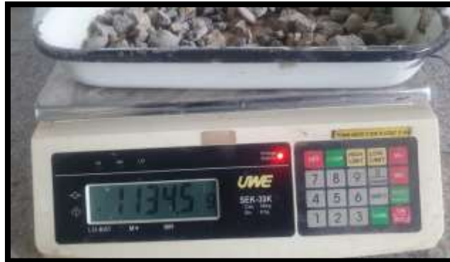
Figura 12. Pesaje de agregado grueso.
