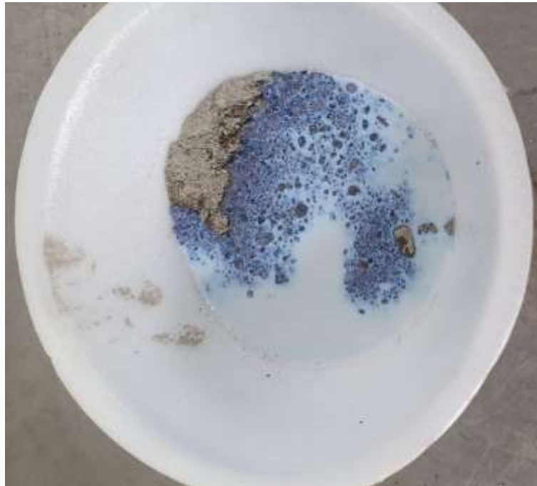
Figura 29. Preparación del aditivo SikaTop.
