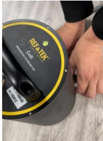
Imagen 3. Nivelación del dispositivo
