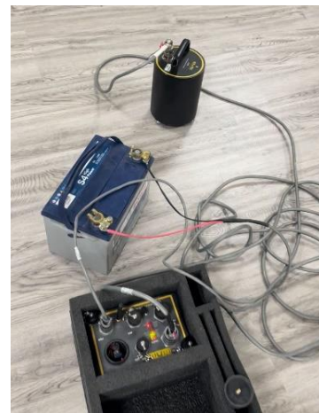
Imagen 8. Sensor, fuente de energía, digitalizador.
