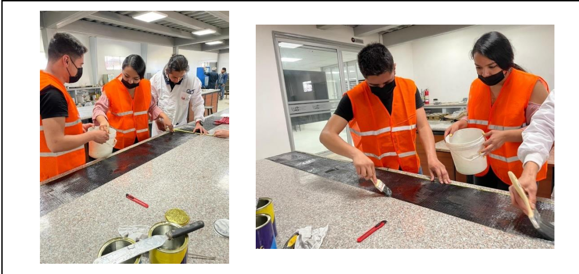
Imagen 18. Aplicación de la Resina sobre las fibras de carbono.
