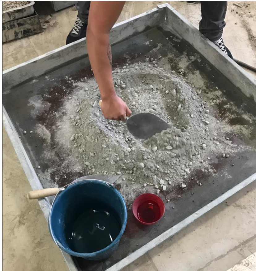
Figura 16. Proceso de mezclado de materiales para el diseño de la mezcla de hormigón.
