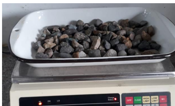
Figura 13. Determinación del peso en estado saturado superficialmente seco (SSS) del agregado grueso.
