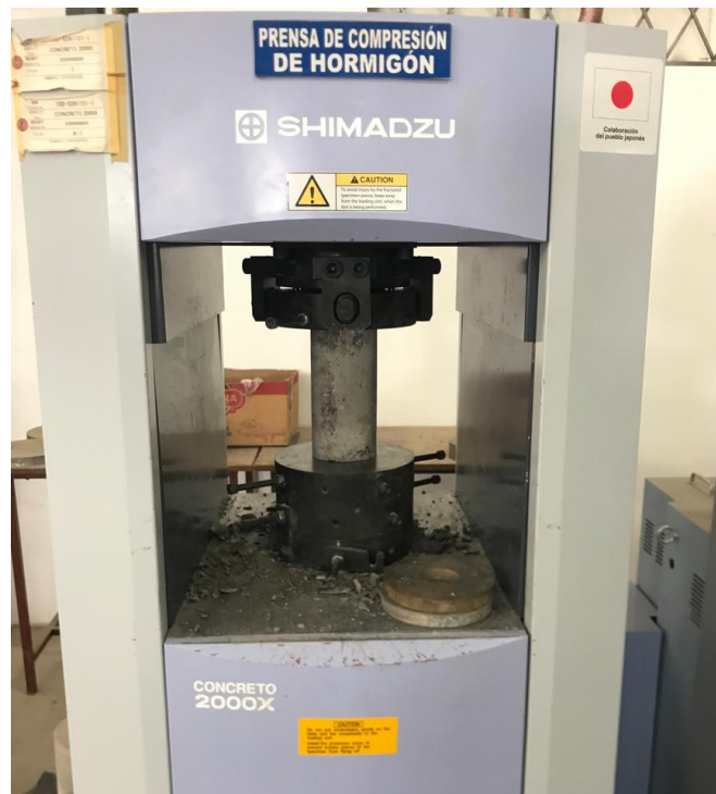
Figura 18. Ensayos de rotura (Maquina de compresión).
