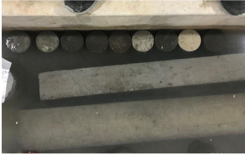
Figura 17. Grupo de probetas en la piscina de almacenamiento para muestras de hormigón.
