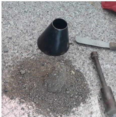
Figura 10. Determinación del estado saturado superficialmente seco (SSS) del agregado fino.
