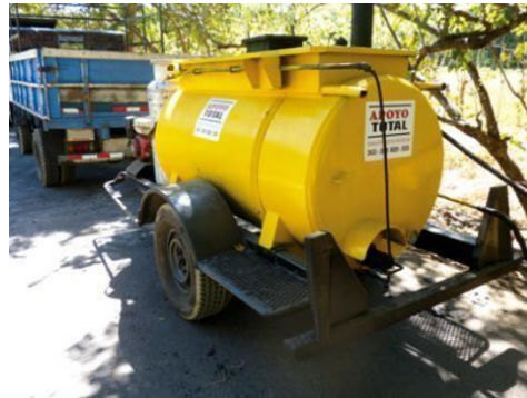
Figura 17. Dispositivo manual de emulsión asfáltica Fuente: (Universidad de Costa Rica, 2019)
