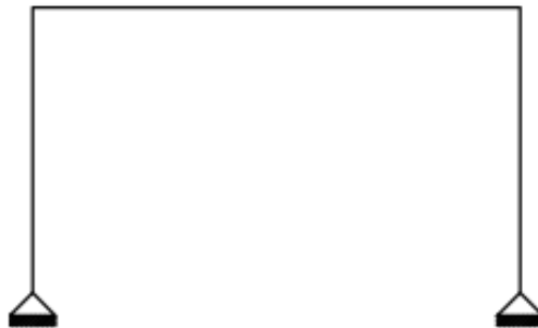
Figura 9: Pórtico simétrico rectangular
