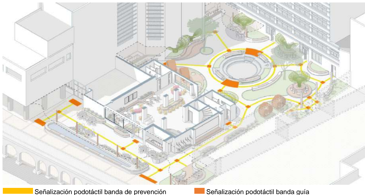
Figura 4.14: Señalización podotáctil: banda de prevención y guía para espacios públicos
