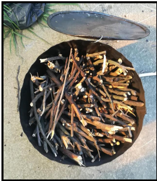
Figura 16: Llenado de la cámara interna con la biomasa seca
