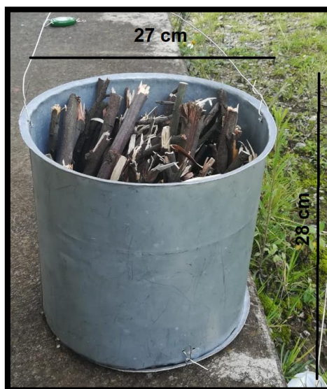
Figura 13: Dimensiones del tambor cilíndrico interno
