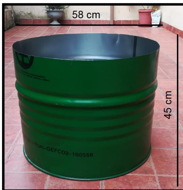
Figura 14: Dimensiones del cilindro externo
