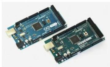
Figura 4. Arduino Mega 2560.
