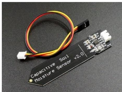
Figura 8: Sensor humedad de suelo
