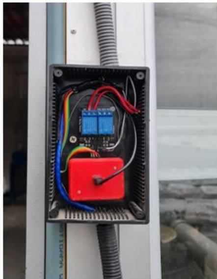
*Figura 57: Instalación del relé para el control de la bomba de agua.*
